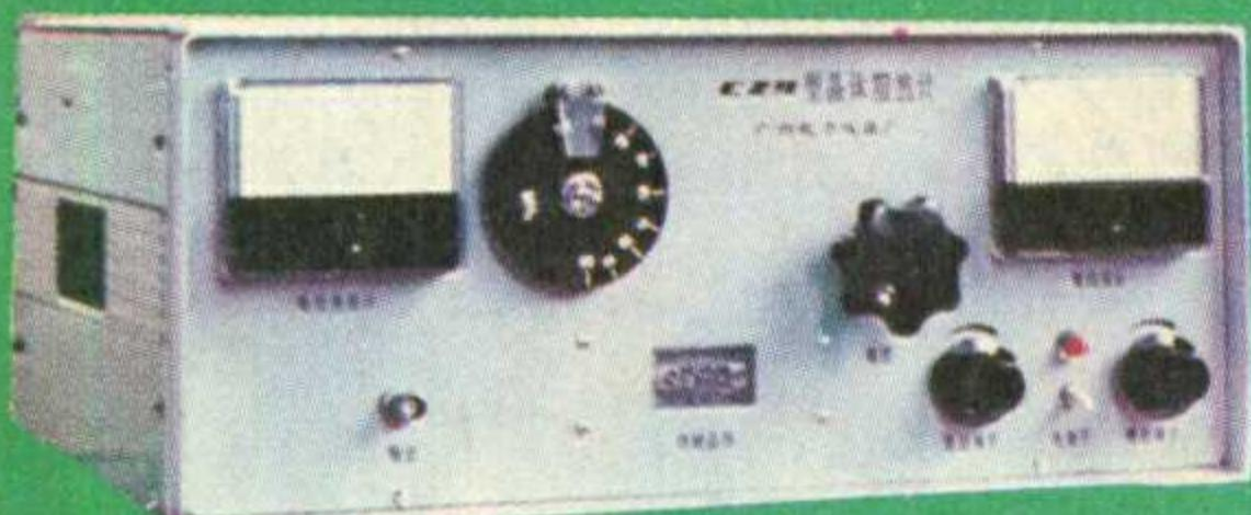
可测量电阻器的电阻值，电容器的电容量电感器的电感量等参数，同时对电容器的损耗因素，电感器的品质因数亦能相应指示，适合工厂企业，广播站和科研单位使用。
