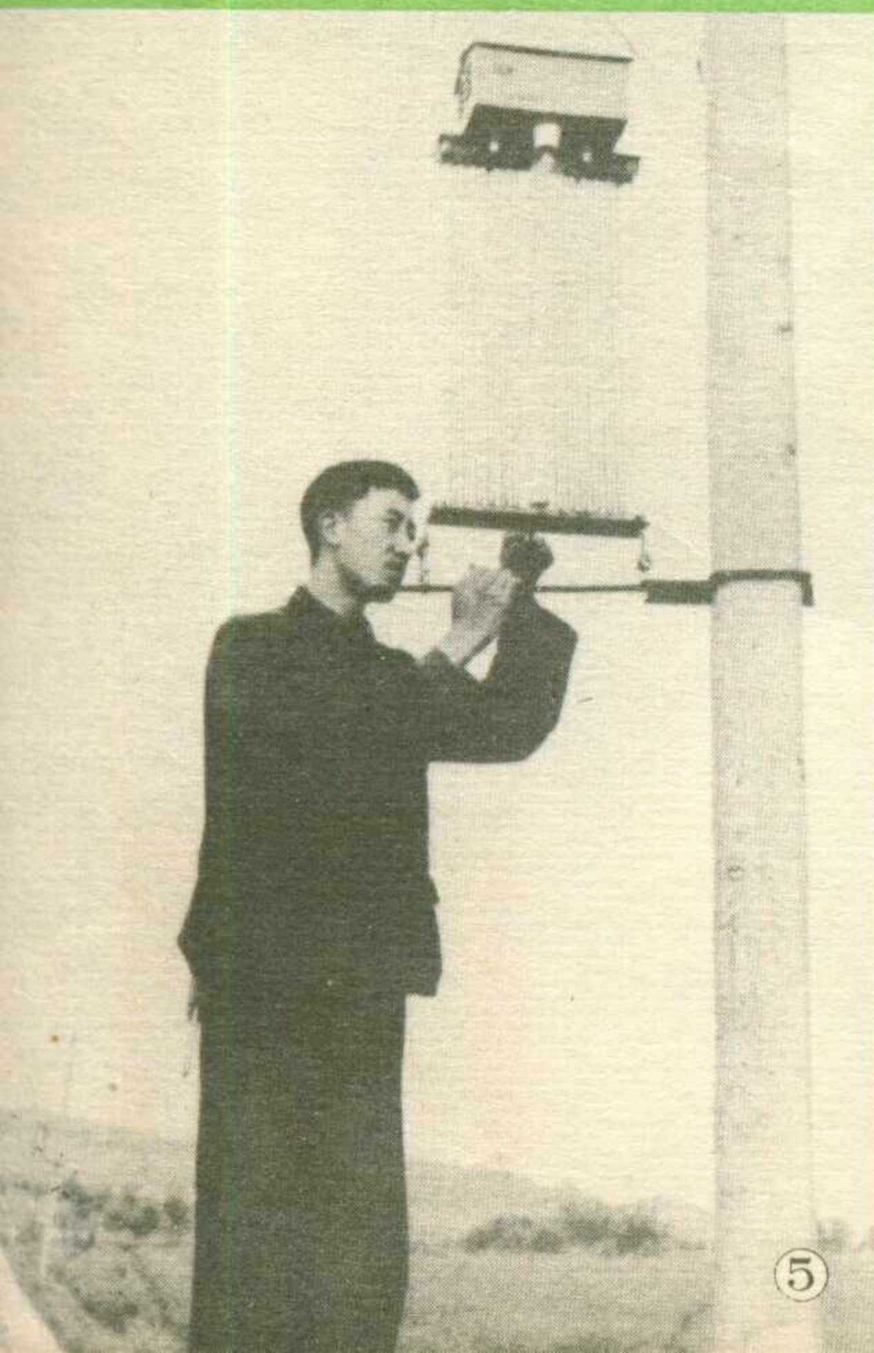
4. 利用积光仪测光强和光照时间，探索农作物生长规律。
