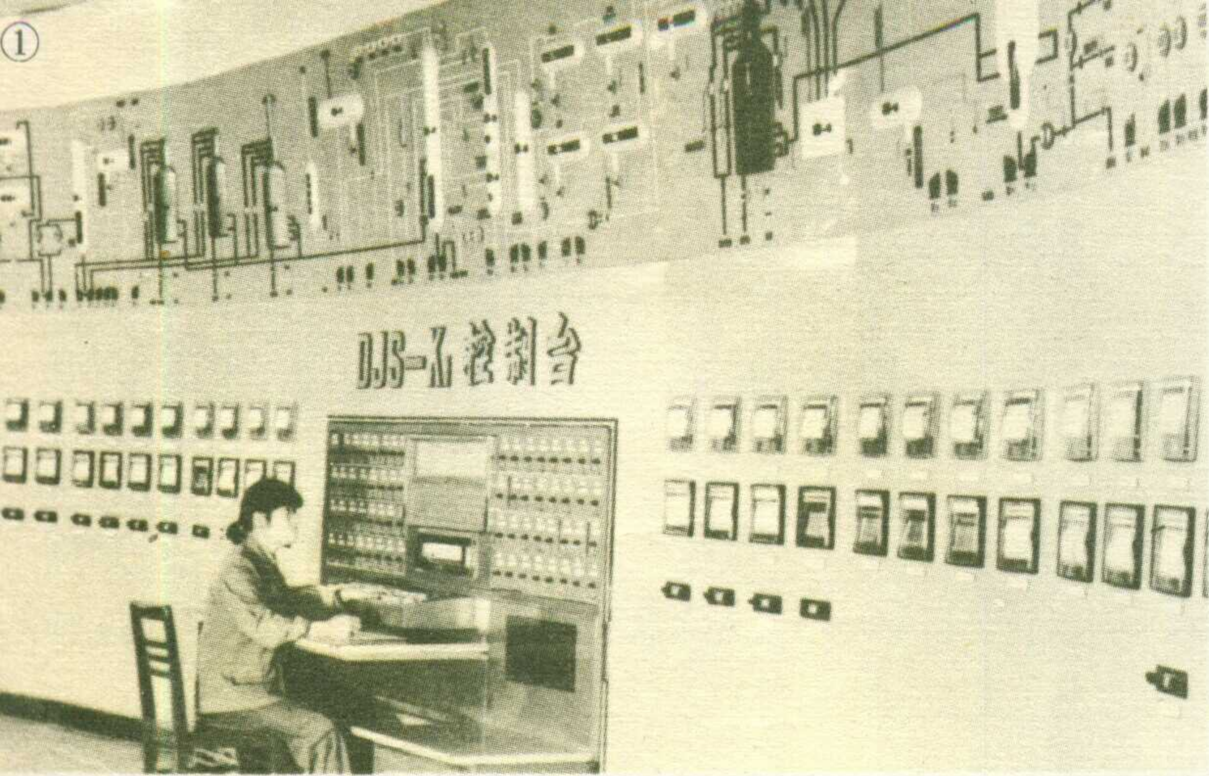
① 南京石油化工厂用电子计算机控制炼油生产。
