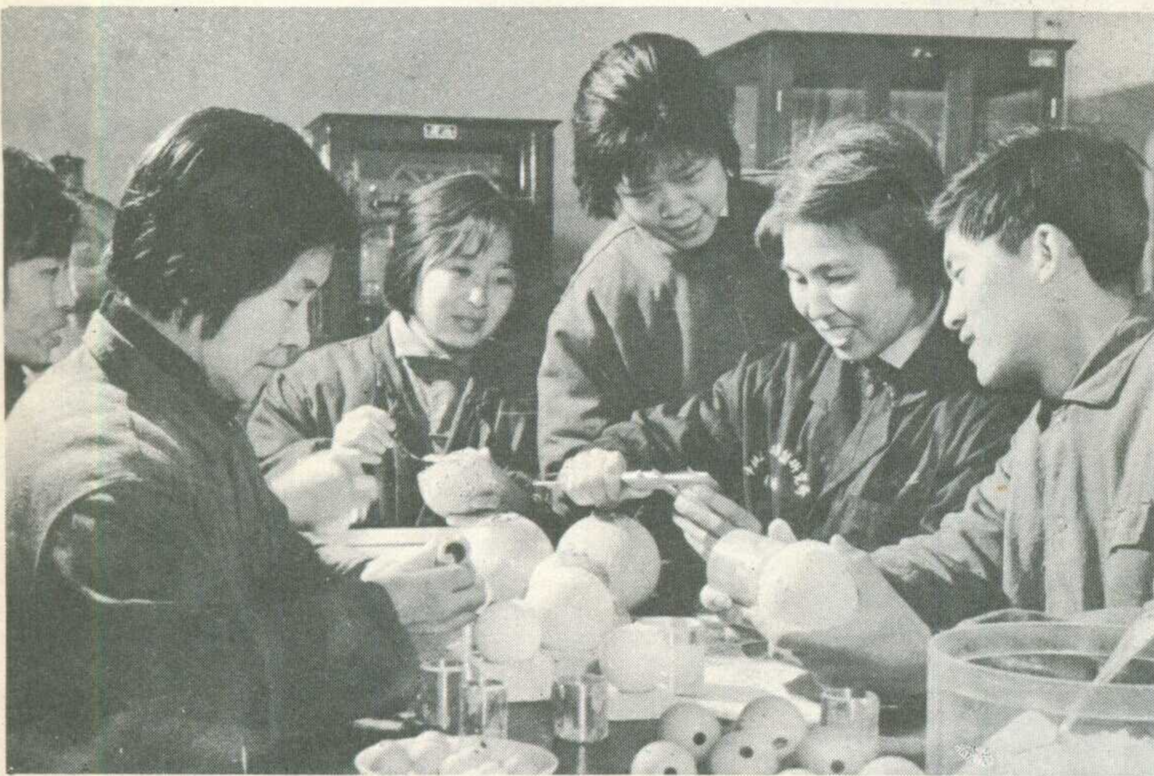
（上）科研人员与上海立新无线电元件厂工人相结合，研制成功的压电陶瓷材料，已由工厂加工成各种形态的元件，在工业生产、国防建设部门中广泛应用。
