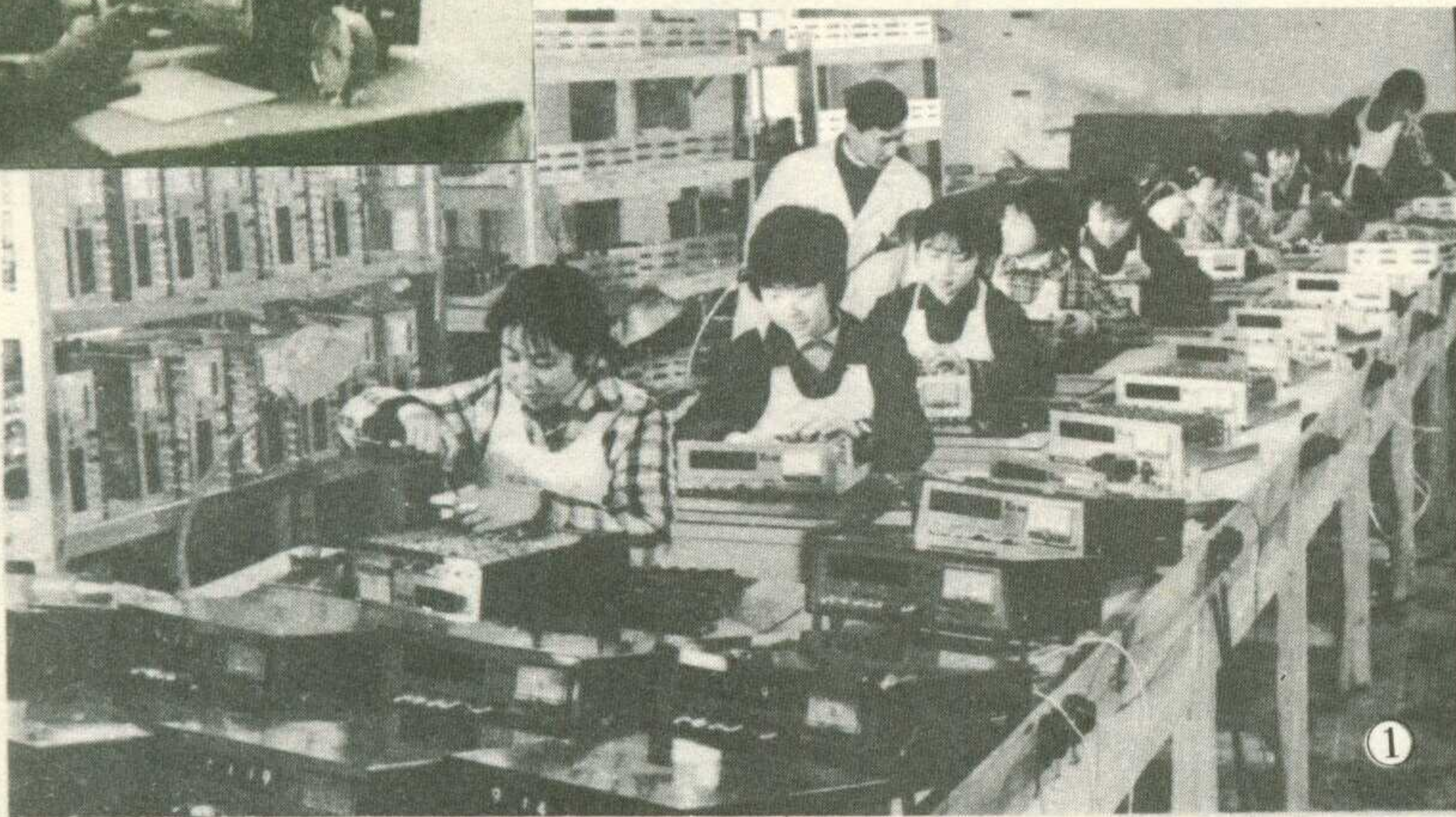
①江苏省宝应无线电元件二厂，为科学保粮创造条件，成批生产XC-1600型温度巡回遥测器。左上：粮库工作人员正在进行粮仓温度巡回检测。
