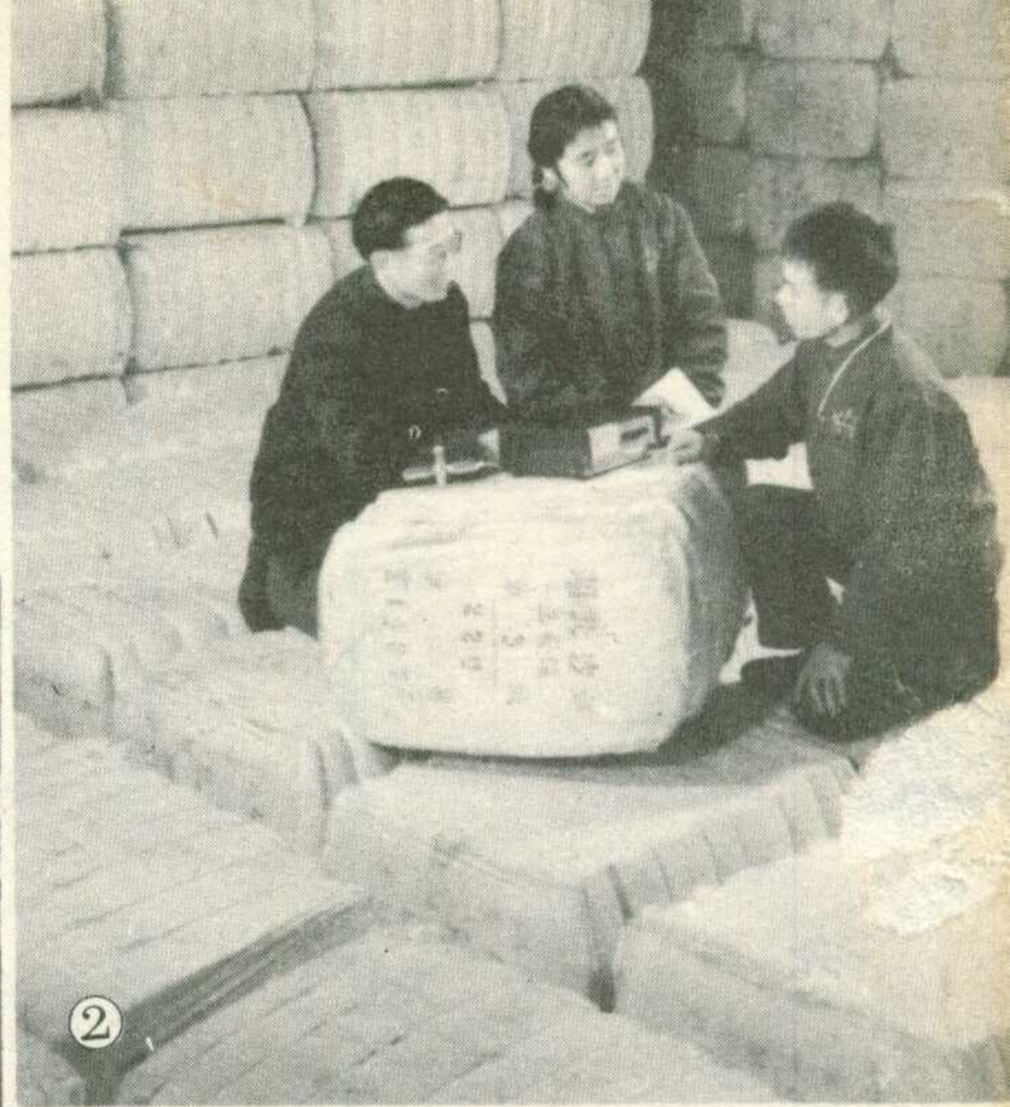
①江苏省宝应无线电元件二厂，为科学保粮创造条件，成批生产XC-1600型温度巡回遥测器。左上：粮库工作人员正在进行粮仓温度巡回检测。
