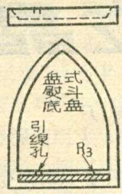
在盘式熨斗底板右缘(垂直面)铣槽槽内装 R_3
