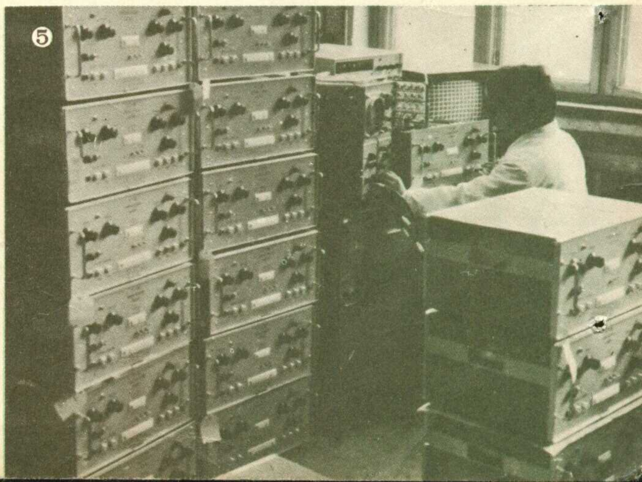
⑤北京无线电二厂新产品 XT1 型图像测试信号发生器，可以产生点格、多波群、阶梯波、正弦平方波等多种测试信号，适合对电视接收机、电视中心台的视频通道进行调测。
