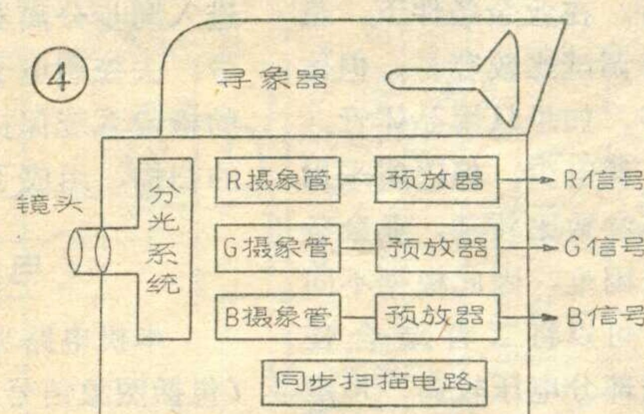
电视图象信号R、G、B的产生是先将电视图象信号经分光系统在三支摄影管的光电靶上形成三个基
