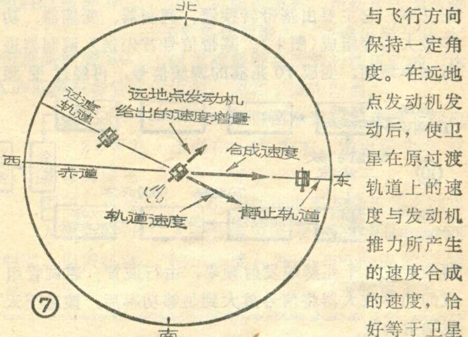
在远地点发动机发动后，使卫星在原过渡轨道上的速度与发动机推力所产生的速度合成的速度，恰好等于卫星进入静止轨道上所需的速度。当卫星进到赤道面上的静止轨道上以后，启动推力喷管，精确修正轨道，最后调正卫星姿态，使卫星自旋轴与地球赤道面垂直。
