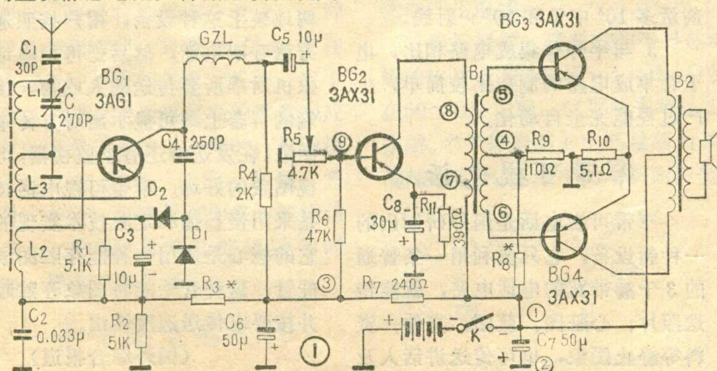
放管 $BG_1$ 和前置放大管 $BG_2$ 不能工作。这时用电压档测图①中③点时，对地无电压。
