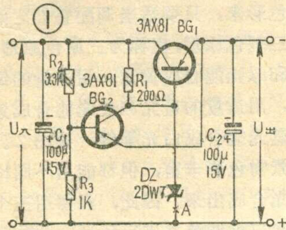
中除 C<sub>1</sub>、C<sub>2</sub> 起滤波作用外，其余元件可分为两部分。
