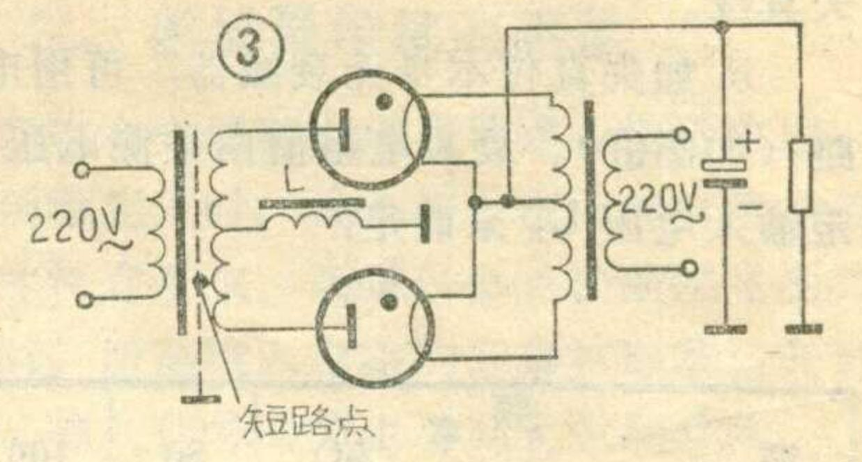
动不了。若高压整流滤波系统把阻流圈装置在高压负端（如图③）的机器，由于有较大阻抗的阻流圈串接在高压绕组回路里，整流回路并非短路，这时可以启动高压，但容易看出一只管子蓝光很大，而另一只管子无蓝光或仅断续的有蓝光。用万用表测时一个绕组有电压输出，而另一个绕组则无电压输出。
