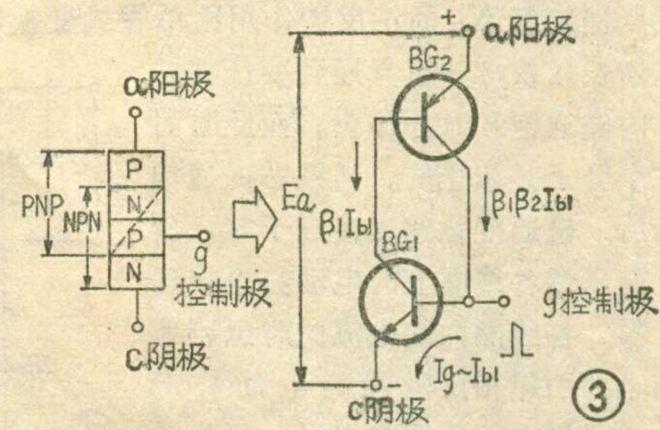
没有输入触发信号或信号极性相反对，即使可控硅加上了正向电压，由于  $BG_1$  的基极得不到正信号而处于截止，可控硅也无法导通。
