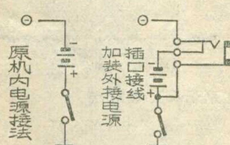
处焊牢即可。为了取换方便可以购买市售成品电池盒，把电池按规定放进去即成。如果有条件，可以加装一个外接电源插口，接线如图所示。这样使用非常方便，外出随身携带时用机内积层电池，在家固定放置收听时可插入外接电源，机内电池就自动断开，节约
