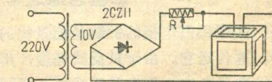
**充电器** 8 瓦黑光灯电源是一个 6 伏小电瓶，充电如图所示。图中 R 为线绕电位器，功率 10—25 瓦，阻值 100—200 欧。整流二极管用 2CZ11，反向击穿电压  $\geq 50$  伏，最大整流电流 1 安。
