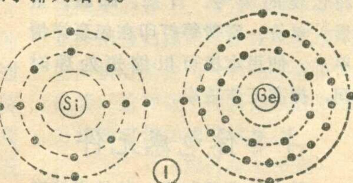
个原子为中心，这个中心原子拿出一个价电子和它的一个邻居原子共用，每个邻居原子也拿出一个价电子和中心原子共用。中心原子有4个价电子，所以它可以用这种方式结合四个相邻原子。这样结合后，价电子一方面围绕自己的原子核运动，另一方面也时常出现在共用它的原子所属的轨道上。每对共用的价电子，使它们所属的两个原子间产生一个束缚力，就像键条一样把两个原子互相拉着。这种靠共用价电子而实现的结合，就叫做共价键（键的意思就是结合）。
