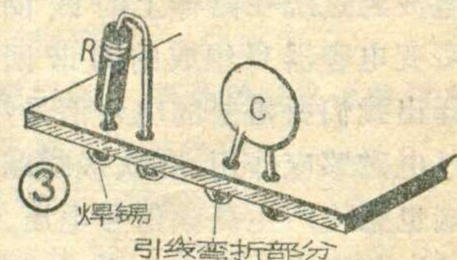
固时用钢针从铆钉内穿一下，等焊锡凝固后抽出钢针，便可留下一小圆孔。然后把要焊元件引线穿过小孔，弯折一下，进行焊接就可以了。
