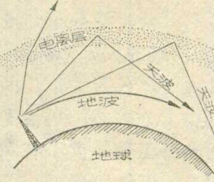
答：这是由于无线电波的传播特性所引起的。一般广播中波或短波波段的无线电波的传播路径有：地面波（简称地波）和天波两种，如图所示。
