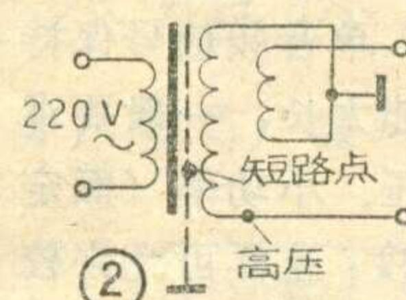
3. 次级高压绕组和静电隔离层局部短路。这多发生在全波整流的变压器中，因两组中靠近静电隔离层的一组里层线圈对它存在高电压如图②。原因多系使用日久绝缘材料变质，绝缘强度降低或绝缘处理不好造成击穿短路。
