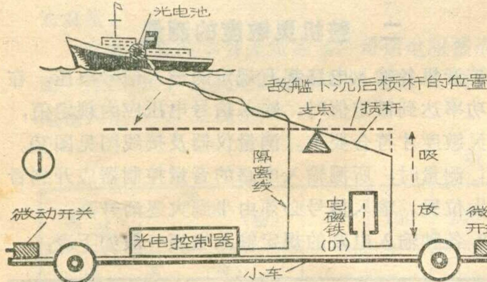
接收部件是一个直径 20 毫米的硒光电池，它装在“敌舰”的中心部位，通过隔离线和光电控制器相连。
