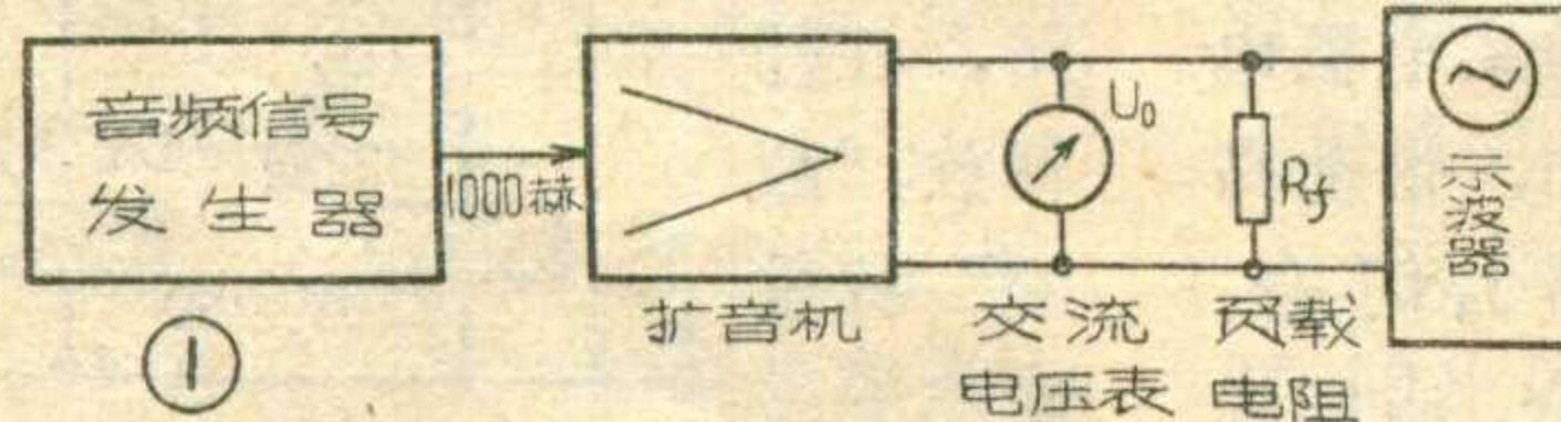
2. 输出端以纯电阻为负载。电阻值按扩音机的额定输出功率 $P_0$ 和输出电压 $U_0$ 计算：
