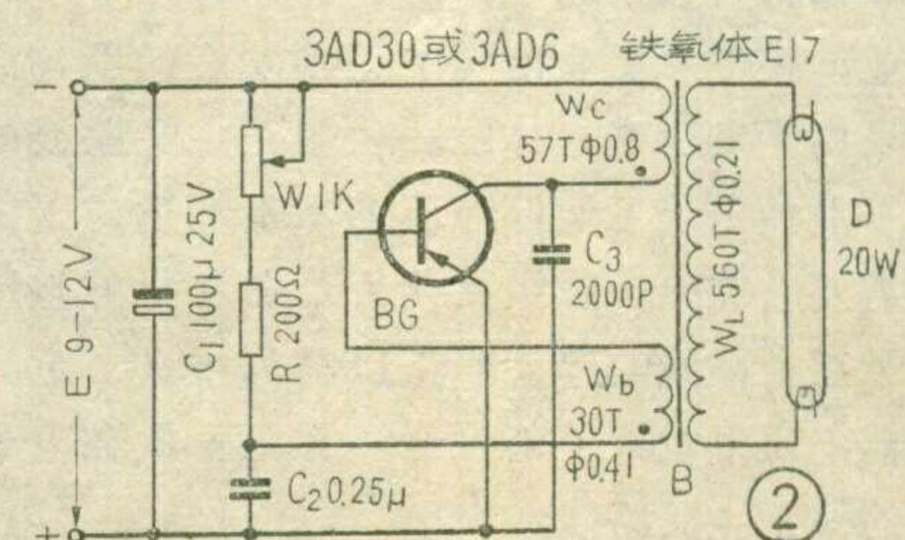
输出的能量储存在变压器的磁场内，截止时能量释放。电源变换器实际上是具有一个电感储能器的振荡器。
