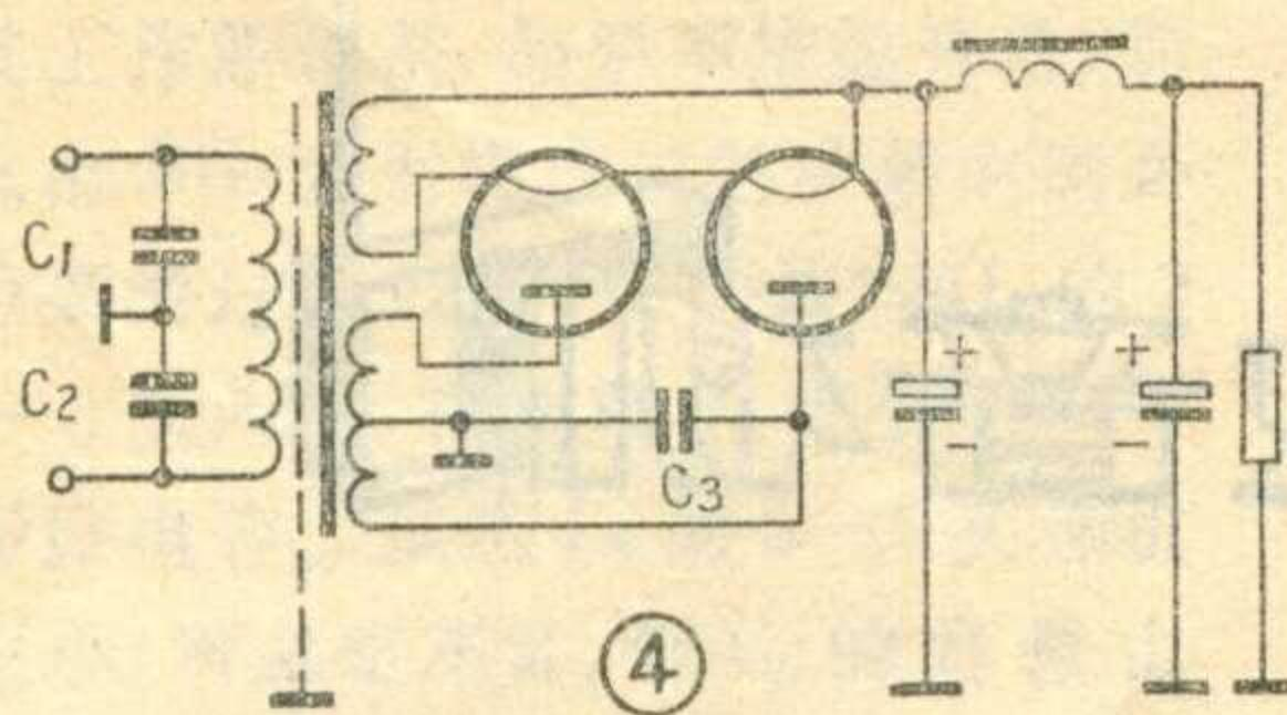
不良或松脱，失去隔离作用而干扰收音，或转播收音时出现明显调制交流声，这在用铝箔作隔离层卷压引出线的变压器较常见。另外用绕一层漆包线作静电隔离层，因为这层绕组两端存在电压更易出现与相邻绕组击穿短路。此外，这种方式对用汞气整流管作高压整流的变压器静电隔离效果不明显，虽无故障，却仍对收音有干扰现象。
