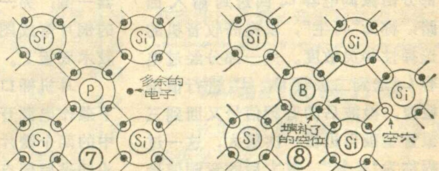
空位，这样就在这个硅原子中产生一个空穴，如图8所示。由于硼原子外层多了一个电子，所以这个硼原子便带负电，对邻近硅原子中产生的空穴(带正电)便有吸引力，使这个空穴受到一些束缚，但束缚力很小，很容易挣脱束缚成为载流子。因此，在这种半导体中，空穴载流子是多数载流子，电子载流子是少数载流子。我们把这种半导体叫做空穴性半导体，简称P型半导体。
