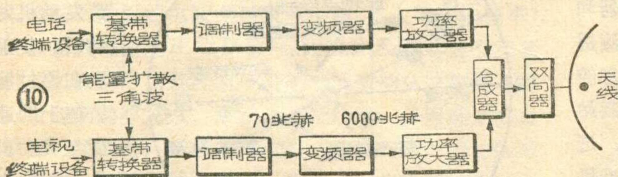
器转换成6千兆赫的发射频率，由行波管、速调管组成的功率放大器将信号放大到足够功率后，馈送至天线辐射出去。
