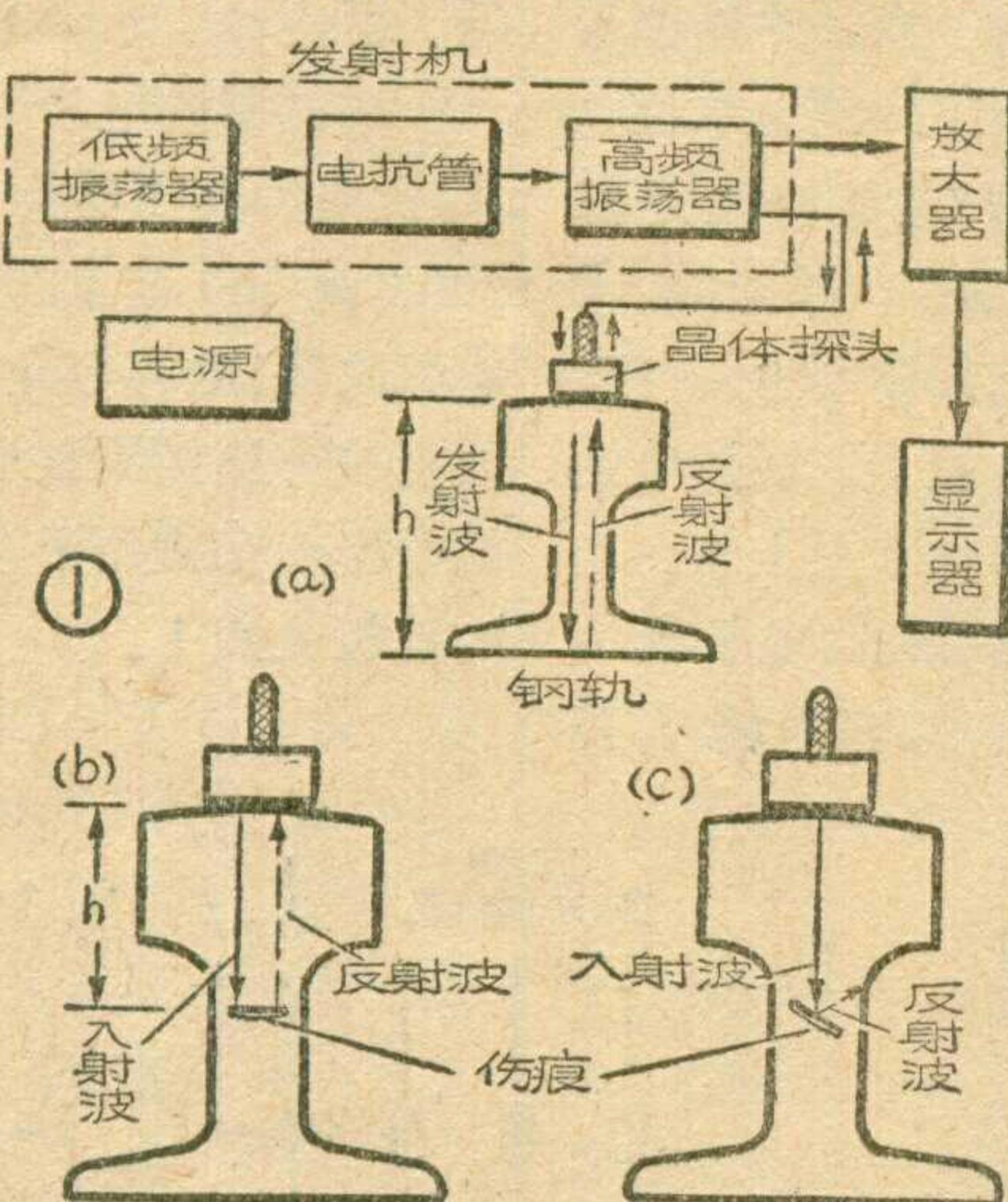
它由调频超声波发射机、晶体
