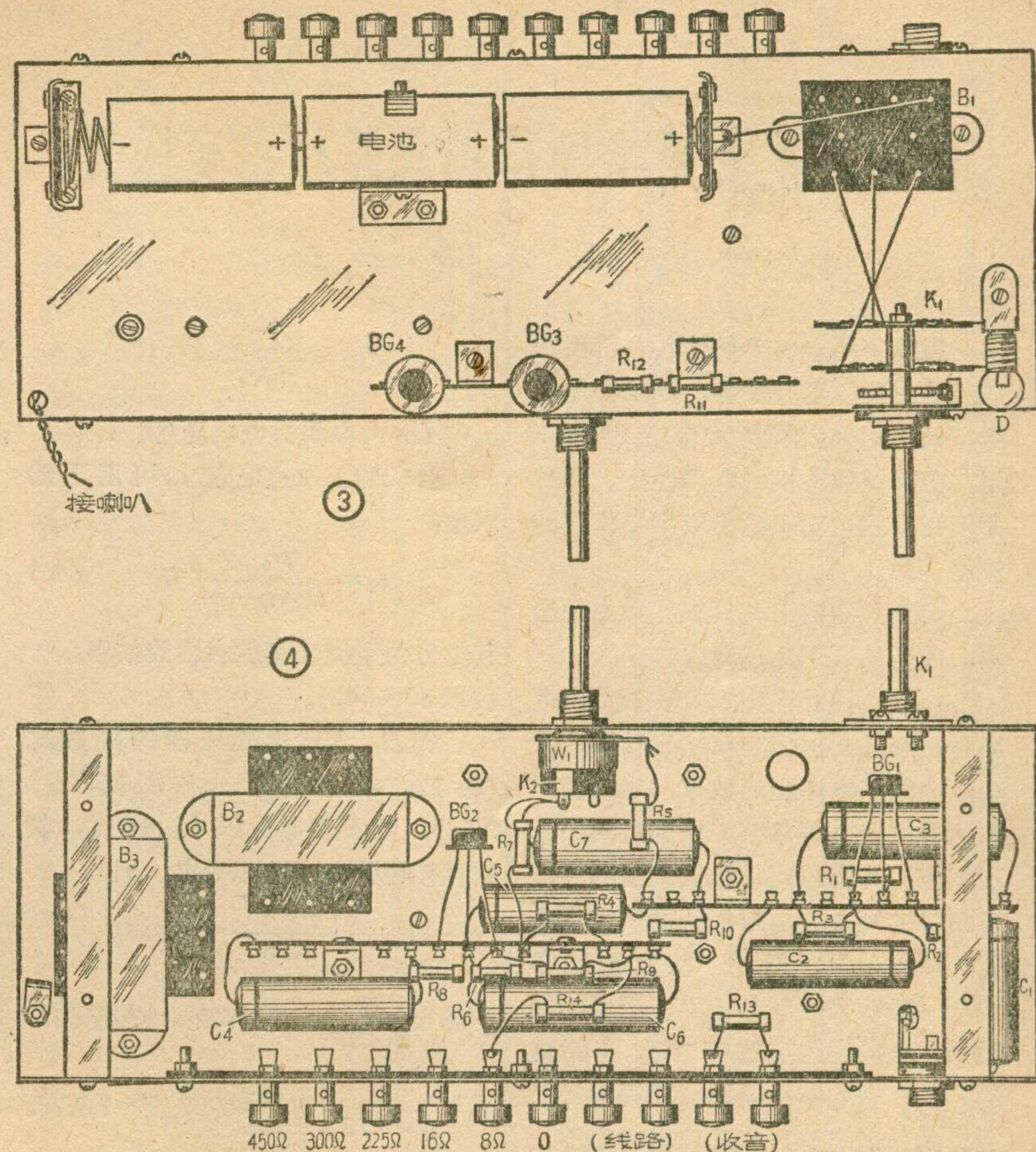
級用直徑 0.1 毫米的漆包綫繞 3000 匝，70 匝处抽头（指监听喇叭为 3.5 欧时，若用其他阻抗的监听喇叭，则最好重新設計）。次級用同样漆包綫繞 1000 匝。
