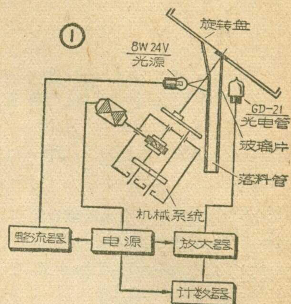
上的光綫作瞬时变化，引起流过負載电阻  $R_1$  的电流也瞬时变小，则在电阻  $R_1$  上产生一负尖端脉冲。
