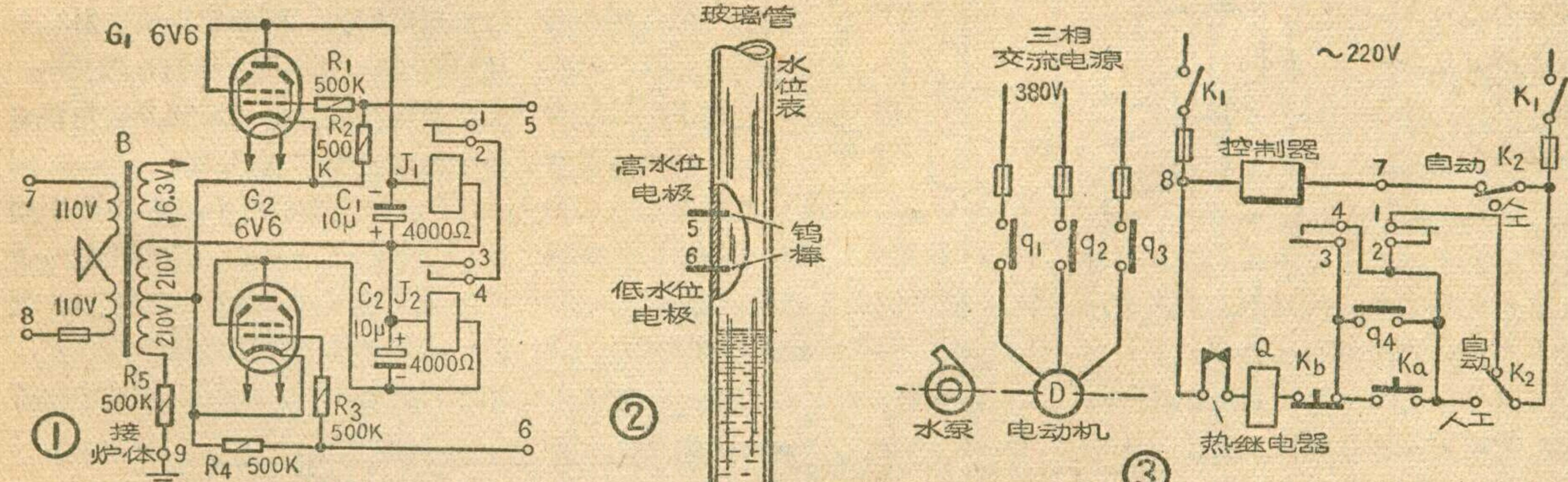
脉冲放大器 ( $\frac{1}{2}G_1$ )：种子在落料管中下落时，从落料管窗孔上边缘起至种子全部通过下边缘所需时间，随种子大小不同而不同。种子厚度为2毫米时，需1.817秒；3毫米时为2.69毫秒；6毫米时为5.34毫秒。
