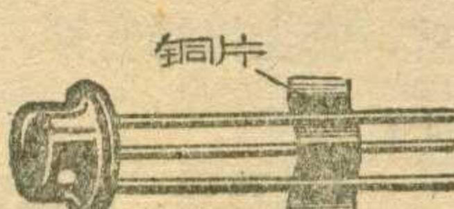
根引线，焊在电阻的两端，就做成了。
