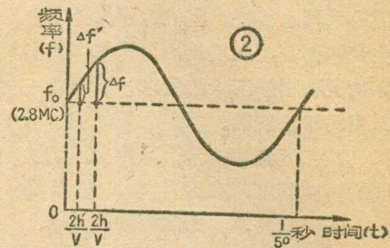
調就有明显的变化。更重要的是，电路中的音频负载是谐振于  $\Delta f$  的，它对频率为  $\Delta f'$  的振荡响应很小。所以当钢轨有伤痕时，输出的音频信号就显著减小，耳机中的声音明显降低，电表指示减小。
