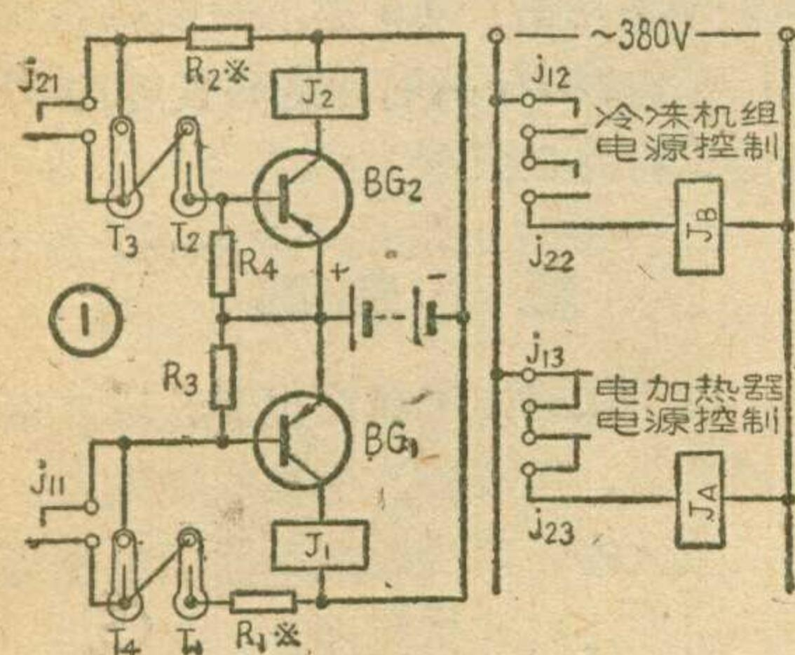
这里介紹的自動控制裝置，能够根据室溫的不同情況，自動選擇電加熱器和冷凍機組的任一種，間歇地工作，以達到控制室溫的目的。用这种方式能大大節約設備耗電，減少設備運轉的機械磨損，延長使用壽命。這對大型、中型空調恒溫設備來說，是非常合適的。
