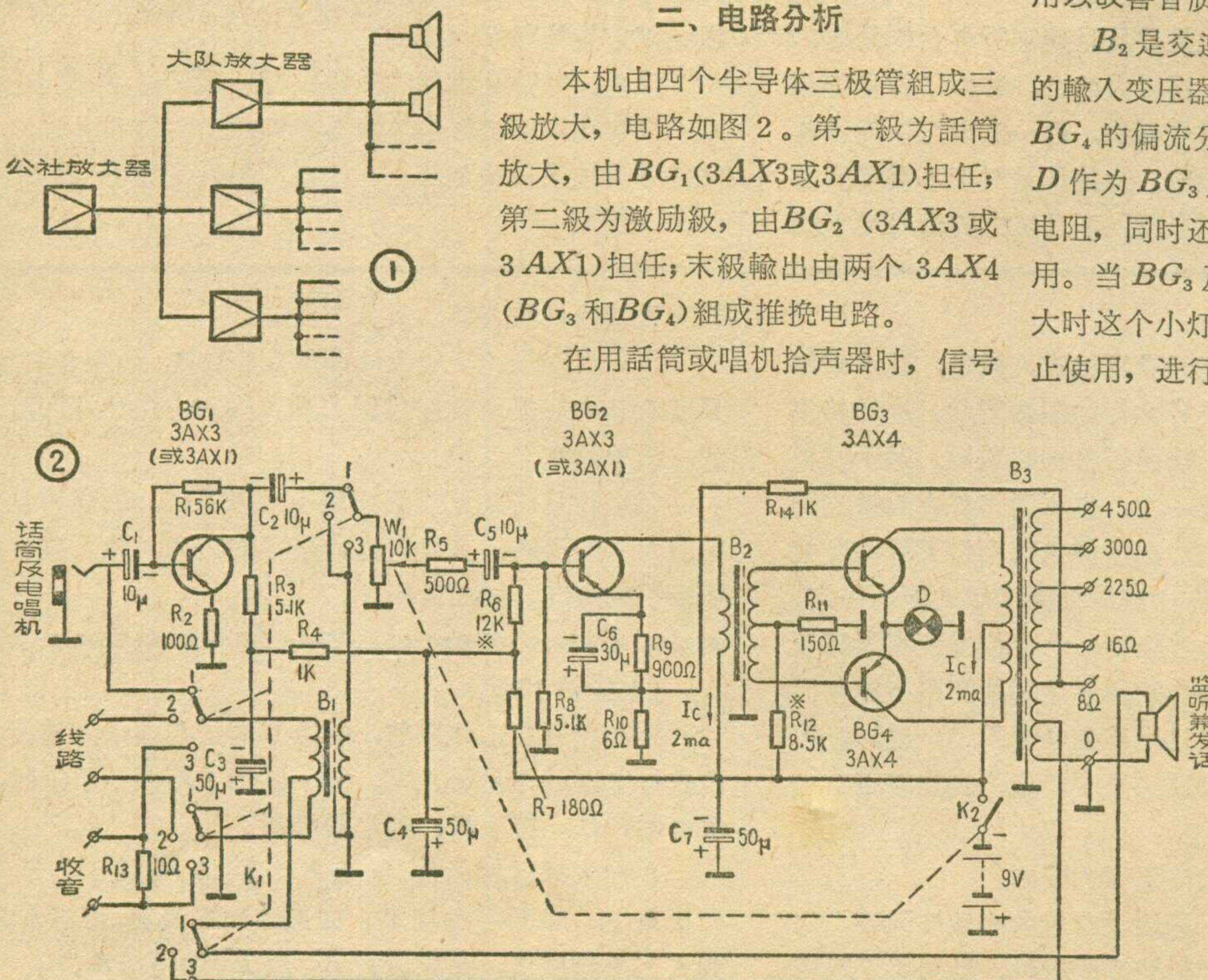
号較高，故經過  $B_1$  及  $K_1$  而直接送入  $BG_2$ ，不再經  $BG_1$ 。用半导体收音机轉播节目时，应将轉播用收音机中的喇叭断开，而将它的輸出变压器次級接到放大器的“收音”輸入端子上。这时 10 欧的电阻  $R_{13}$  就作为收音机的負荷。同时  $K_3$  放于“3”位置。
