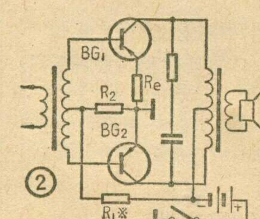
另一种办法，是在 $\beta$ 值較大的管子的发射极串接一只电阻 $R_e$ （图2），通過 $R_e$ 产生的
