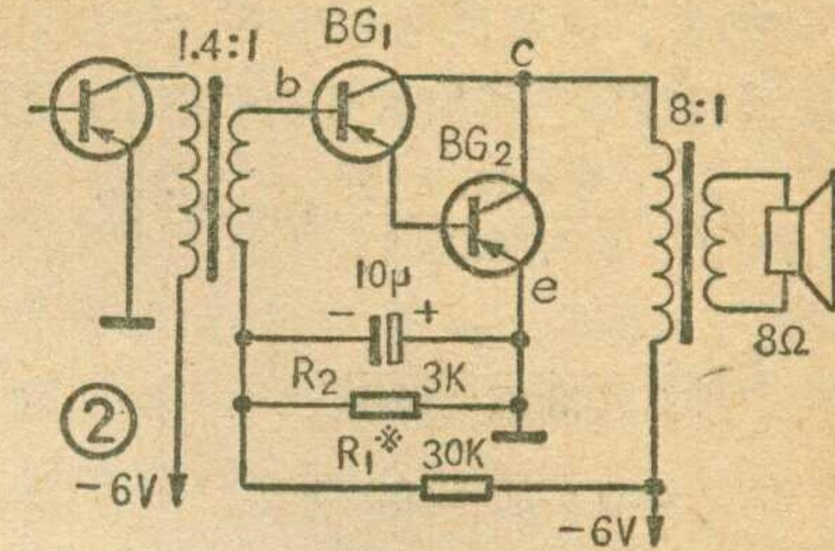
当采用变压器作級間耦合时，輸入变压器的初次級圈数比根据所用管 $\beta$ 值的不同可从1:1到2:1。图2为一实用电路，复合管仍由上述两个3AX1管构成，实验表明，其效果同样很好。
