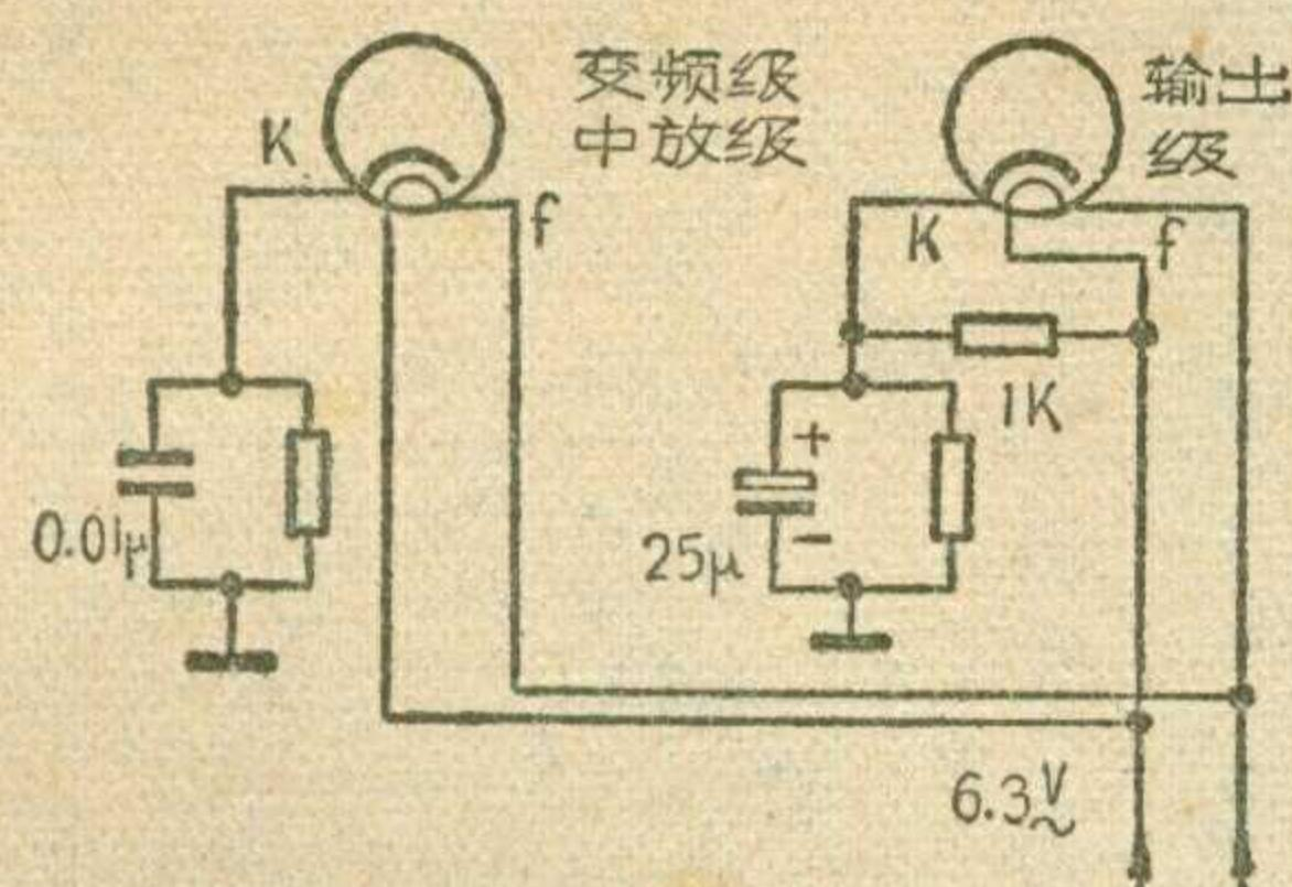
前級管阴极上接有电阻，旁路电容又很小，那末，这部分交流成分，就降落在阴极电阻上，也就是接在阴栅之間，經過以下各級放大，即成交流杂声源。在灯絲和阴极間加接一直流电压，使阴极对灯絲的电位为负，这样，就对灯絲的电子放射，起到一定的抑制作用，从而减小了交流成分的影响。加接直流电压比較简单的方法，可以利用末級的自动偏压，如附图接法。图中用一个 1K 电阻把末級阴极自动偏压的正端接到灯絲一側，由于灯絲源沒有接地，末級偏压較其余各管偏压都要高，因此其余各管的阴极，对灯絲都带有负的极性了。这就是为什么旁热式阴极接收管的阴极和灯絲間加接一直流电压后，能降低灯絲交流杂音的原因。
