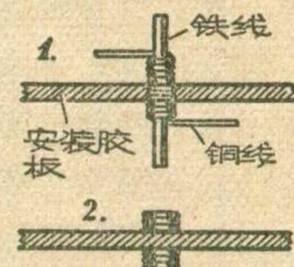
3. 分別将两端留下的線压在第一层線上，并向底板密繞过去，使其紧压在底板上，然后将多余線头剪掉，抽去作为支持物的铁線，这样可供焊接線路用的空心釘就制成了(图 2)。
