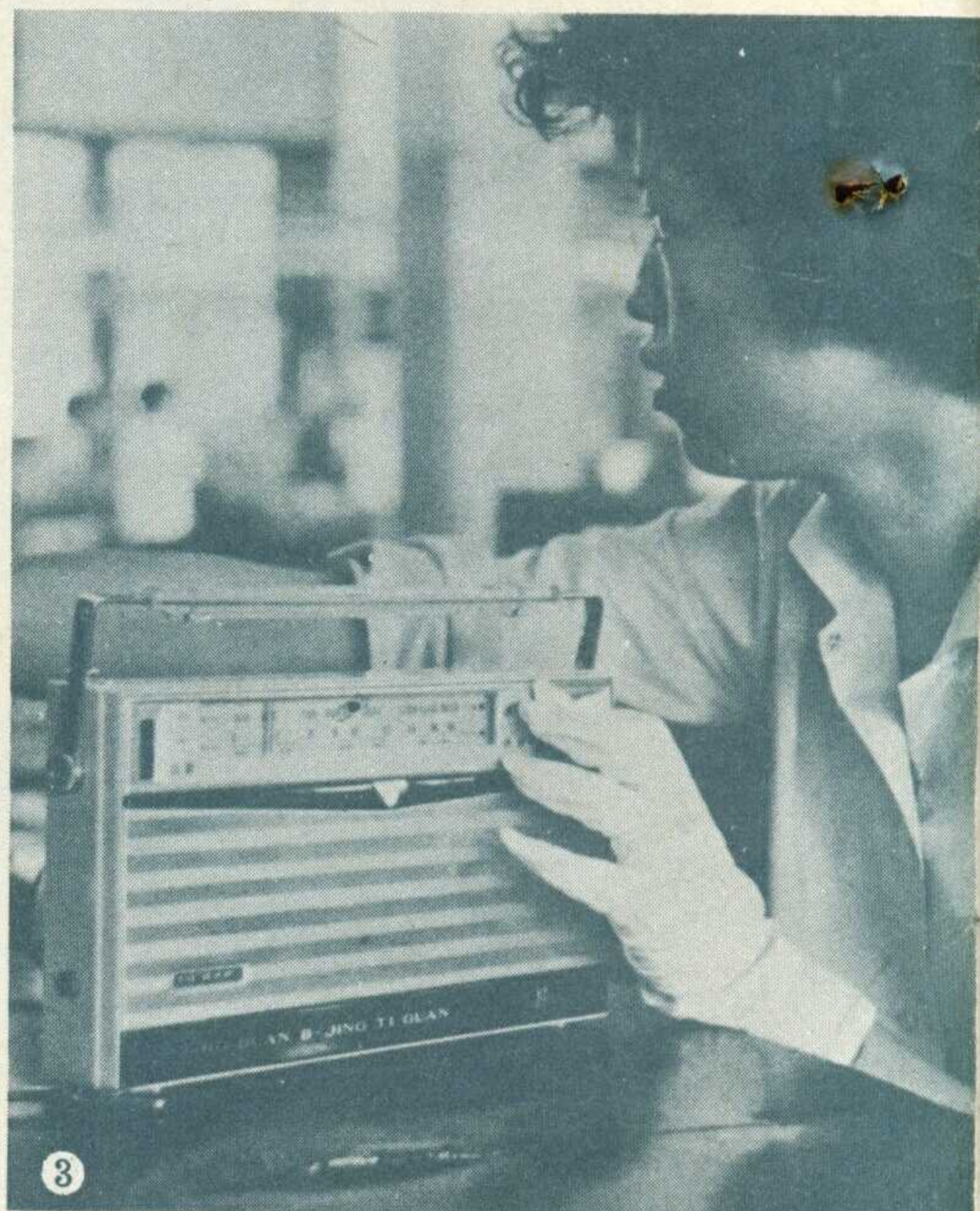
③一种比较高级的便携式美多 28B 八管半导体收音机，已在上海无线电三厂小批投产，这种收音机有短波和中波波段，可供边远地区使用。 (新华社记者 杨溥涛摄)
