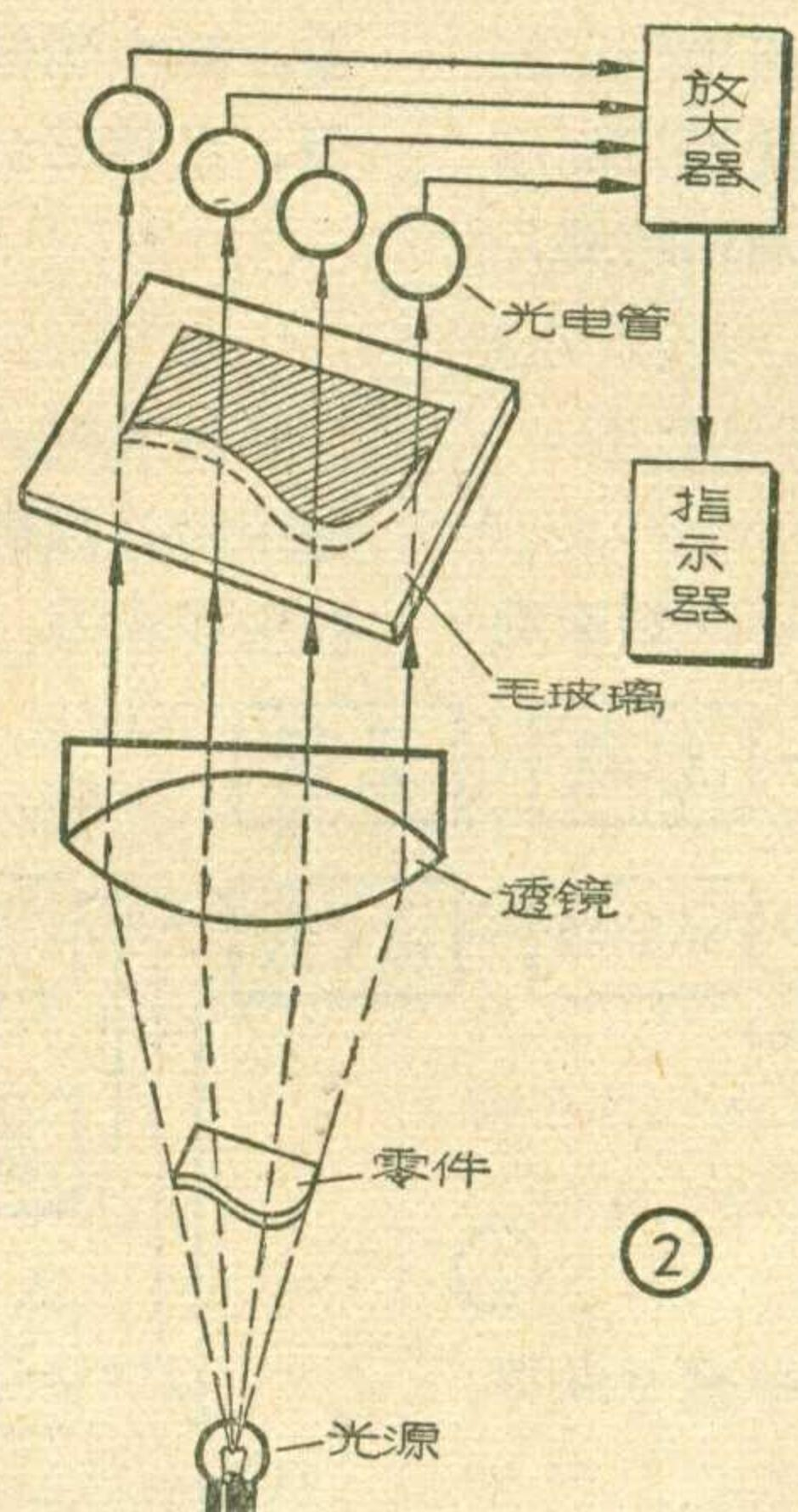
廓用光源照射，经过透镜系统放大，被放大的工件轮廓投影在光电投影仪的毛玻璃上；阴影轮廓为零件的合格形状，其与虚线间的一条空白带为零件形状的允差范围。如零件的形状误差超出此形状带，即为废品。该仪器在沿零件形状允差范围的二极限位置上放有两排光电二极管。一旦零件轮廓的投影象超出此公差极限时，光电二极管即发出信号，通过放大器放大，点亮信号灯，指示零件形状误差。
