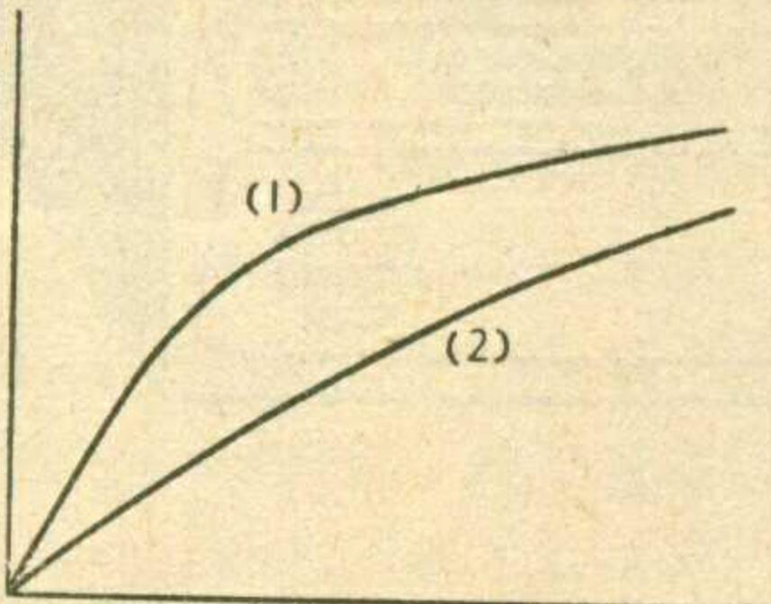
风速与电流的关系如曲线1所示，风速增大后，电流变化也相应减小。若在热敏电阻部分装置一层金属网，可以缓冲风速，使电流随风速的增大仍有明显的变化（如曲线2），而扩大风速测量范围。
