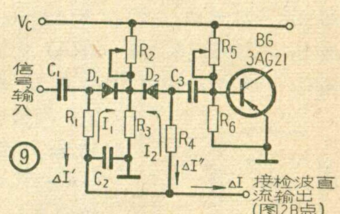
图 9 的电路和图 8 类似，作用原理是一样的，由于多加了一个二极管，由于外来信号增强而增加的检波直流输出  $\Delta I$  分成两部分  $\Delta I'$  与  $\Delta I''$ ，与此相应的有两个反向电压分别加到控制二极管  $D_1$  与  $D_2$  起控制作用。由于多用了一个二极管，使强信号受到更多的衰减，所以效果更为显著。 $C_1$ 、 $C_2$ 、 $C_3$  可在  $0.01\sim 0.1 \mu F$  内选用。 $V_C$  一般可选用  $-4.5\sim -9$  伏。
