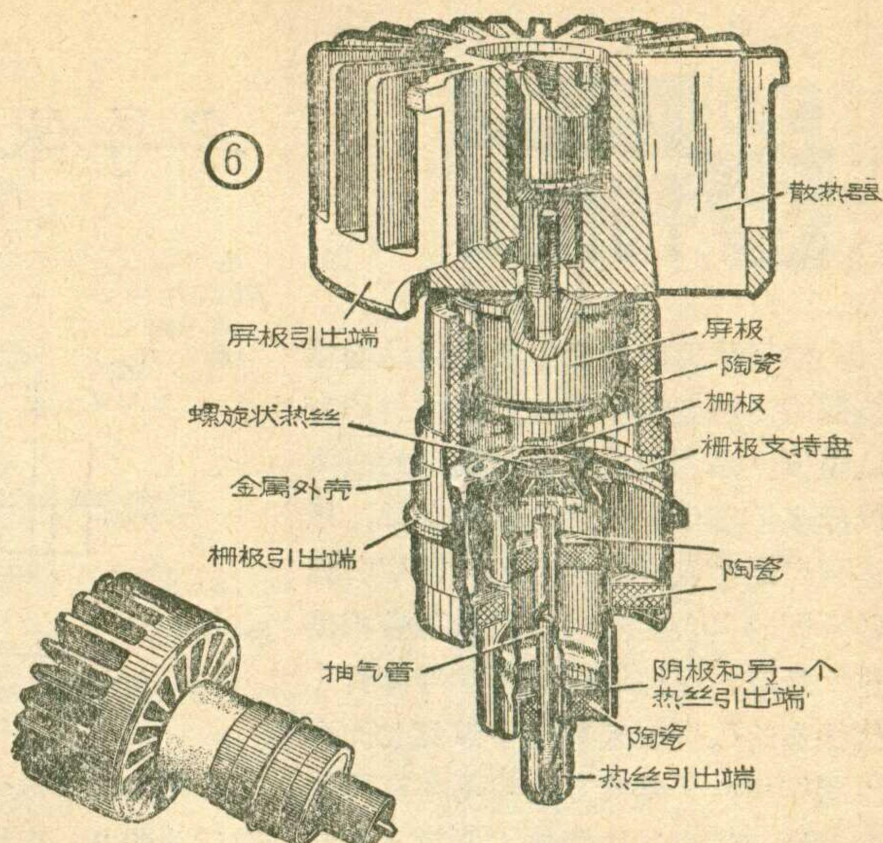
的高頻接头和直流接头。阴极空心圆柱体底部焊有一个金属圆盘，在这个盘与金属底樞的內壁之間放置一块云母片，于是就构成了一个按置在电子管內部的云母电容器。此电容即作为电子管与外电路連接时的隔直流电容器，它的等效电路如图 5 所示。当实际使用灯塔管时，通常都把它的屏极直接接地，而屏极直流高压是将电源的正极接地并把负极饋到阴极的直流接头来获得。由于該管内部已有阴极隔直流电容，就不必再用外部隔直流电容器而直接把諧振回路接到阴极的高頻接头。这样就实际上消除了隔直流电容器的引綫，免除其引綫电感的影响，有利于提高工作频率。
