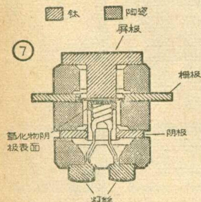
种新型超高頻电子管。图 7 是这种管子的結構剖面图，其工作原理和灯塔管相同。但圓盤形电极使用能耐高温的钛制造，这种金属非常活泼，有极强的吸气作用，因而电子管内不必加入吸气剂。
