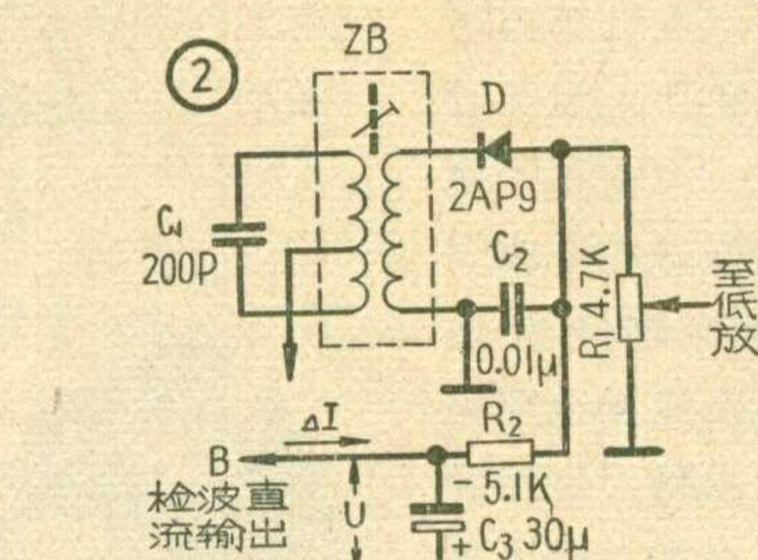
图1的检波二极管也可以反接，便成为图2，电路的其他部分与图1完全相同，唯当外来信号增加时，检波后的直流电流增量ΔI的方向由于半导体二极管反接而与图1中的ΔI的方向相反。
