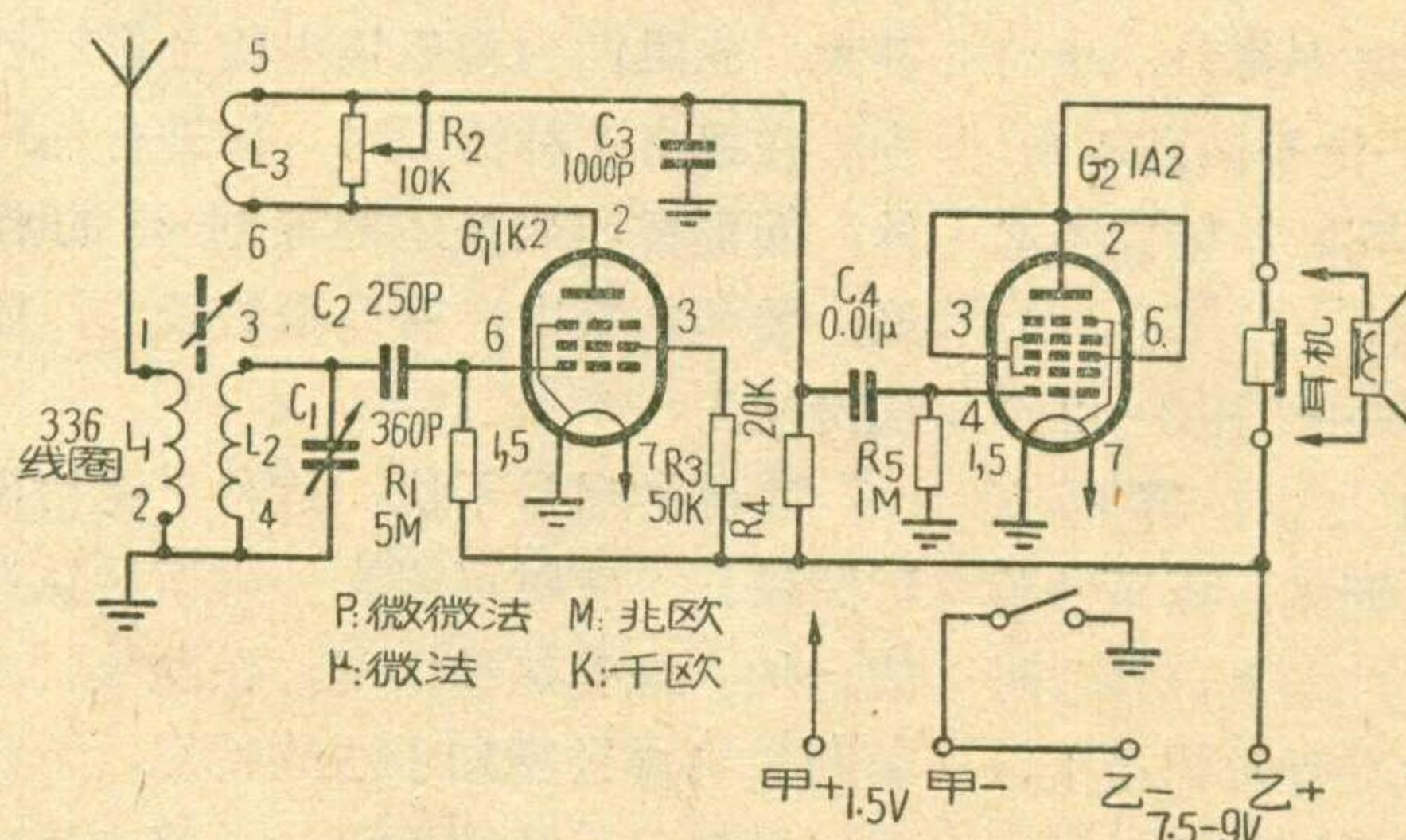
1A2的第二、三、四栅和屏极相連,使电子能够順利地从阴极飞向屏极,因而电子管能在低屏压下工作。线圈是采用336号再生线圈,在线圈內加有磁性瓷心,因而增加了再生强度,提高了灵敏度和选择性,并具有磁性天线的性质。装置时应把线圈水平放置在底板上,用50~70毫米的铁淦氧磁性瓷棒包上一层紙,插入线圈管內,調諧到最佳位置后加以固定即可。由于采用了磁性天线,所以对天线的要求不高。我們采用室内天线,在天水可以收到四川、陝西、宁夏、安徽、山东、云南、内蒙古等许多电台的播音,而且声音还不小。
