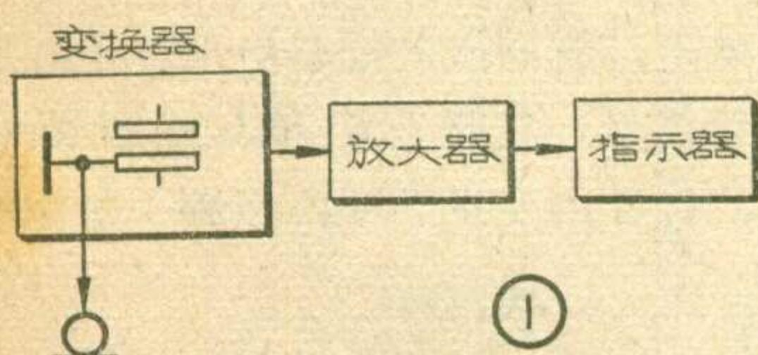
式变换器变成电容量的变化。电容量的变化通过电桥线路转换为电压（电流）振幅的变化，微小的电压（电流）信号经放大后，由指示器可读得被测零件的尺寸误差。
