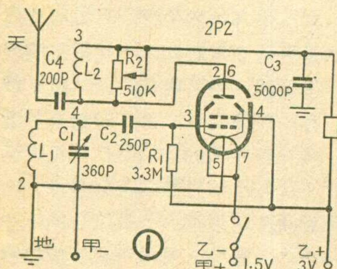
天线信号输入方式,是决定本机成績优劣的关键。据实验結果:天线信号可从 $L_1$ 或 $L_2$ 输入,但是,天线信号从 $L_1$ 输入远比不上从 $L_2$ 输入效果好。天线信号从 $L_1$ 输入,它所收到的只是較近的几个电台,而且音量也較輕。但是,如果天线信号如图示的办法输入,则收程大增,电台增多,而且声音也較响亮。电位器 $R_2$ 是调节再生用的,如果发现沒有再生,可将再生线圈 $L_2$ 两头对调一下试试。
