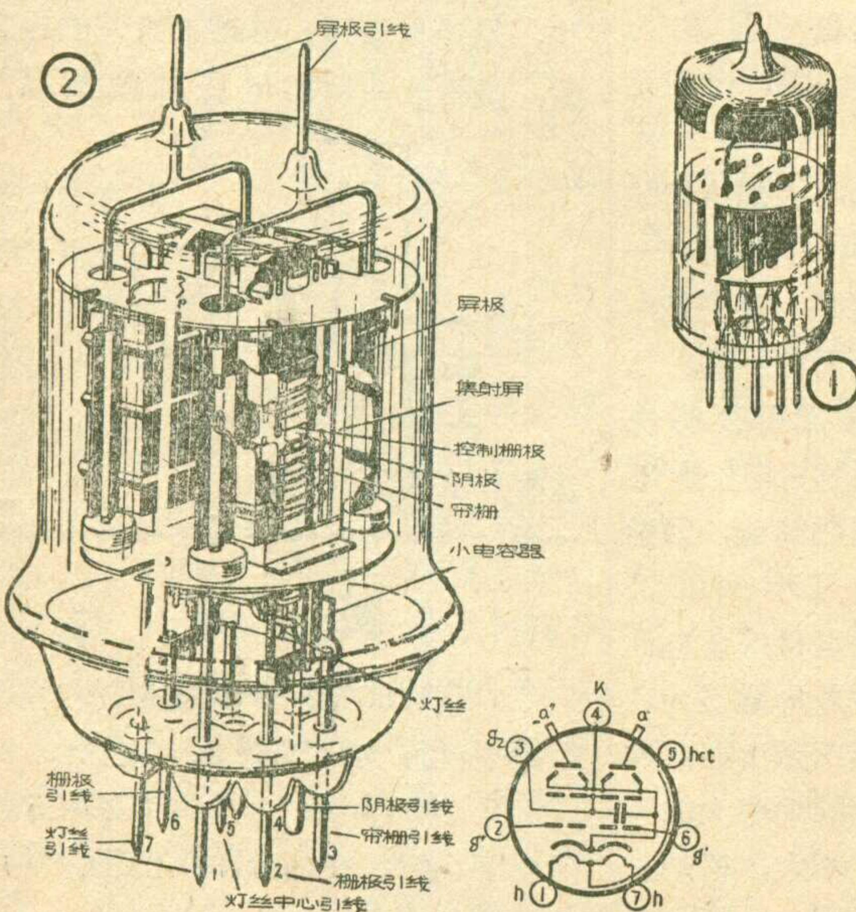
是接收用的小型雙三極管6N3，常用在電視接收機中作超高頻電壓放大和變頻級。圖2是超短波發射用的束射雙四極管FU-29，常用于米波發信機作功率輸出級或在工業上作超高頻振蕩器，其額定功率為45瓦。
