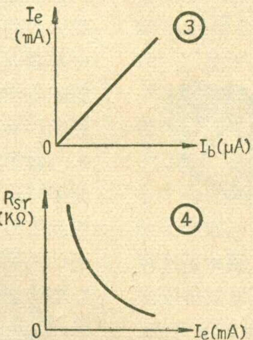
在分析具体电路之前，我们先把两种特性曲线提一下：其中一种是发射极电流 I<sub>e</sub> 和基极电流 I<sub>b</sub> 之间的关系曲线，如图3所示。它说明 I<sub>e</sub> 随 I<sub>b</sub> 成直线性地增大。图4所示另一种曲线表示半导体管输入阻抗 R<sub>sr</sub> 和发射极电流 I<sub>e</sub> 之间的关系。随着 I<sub>e</sub> 的增加，R<sub>sr</sub> 逐渐减小。
