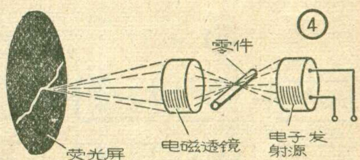
为了研究零件表面的微观几何形状，可以用电子射线投影仪来检测。它是利用电子射线的直接投影来观察表面微观几何形状，所以能看得见被测表面的实际轮廓。工作原理如图4所示。零件的检测工作是在真空中进行的。把被测零件摆在电子发射源与电磁透镜之间。由电子发射源发出的电子束与被测零件母线相切，经电磁透镜聚焦，投射在荧光屏上。因为电子不能通过零件的凸出部分，而能从凹入部分穿过，因而电子束就把机械零件的真实轮廓形状准确地显现在荧光屏上。电子投影仪本身没有读取装置，而是把投影在荧光屏上的微观几何形状的轮廓拍摄下来，再根据图片计算粗糙度的峰高。
