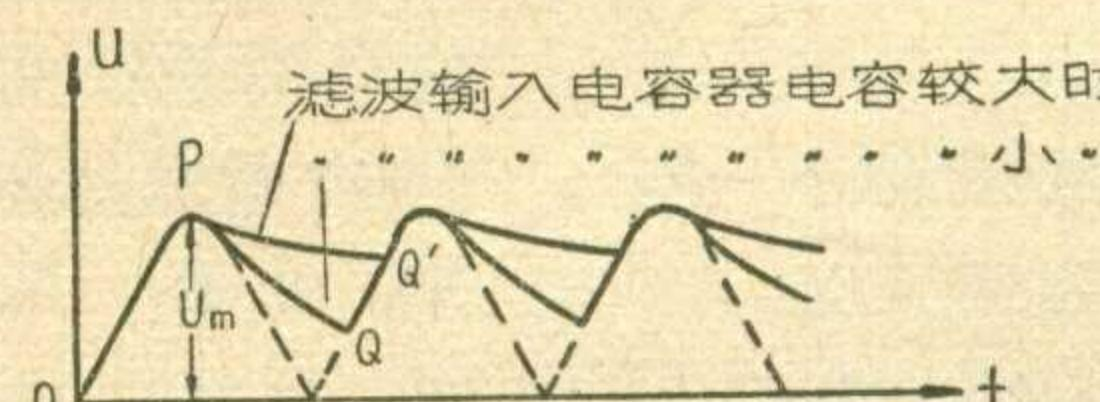
出电压波形，是在两个不同输入电容的情况下作出的。可见电容大时，输出的电压平均值就高，但从波形中可以看出，最高也只能等于整流的峰值电压  $U_m$ 。所以单纯以增大滤波输入电容，来增高输出电压的话，提高的范围是有限的，而且滤波电容用得过大，充电未达峰值就又开始放电，输出的电压平均值反而低落。
