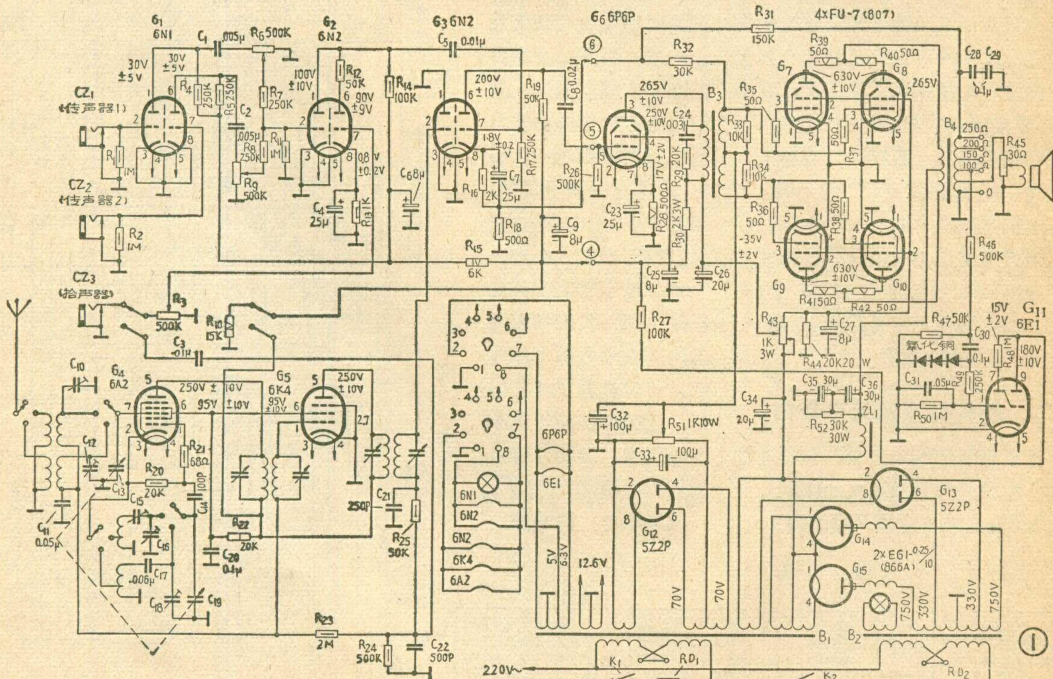
电阻 ( $R_{52}$ )，这样使得四只 FU—7 电子管能得到很稳定的高压供给。另用一只 5Z2P 管 ( $G_{13}$ ) 接成全波整流器，作为推动级及以前各级和收音部分的电源，同时还供给四只 FU—7 管的帘栅极工作电压。再用一只 5Z2P 管 ( $G_{12}$ ) 接成为丝极接地的全波整流器。它的输出电流经  $R_{51}$  大量泄放后，给出一个稳定的负 35 伏丙电压，作为 FU—7 管的固定偏压。
