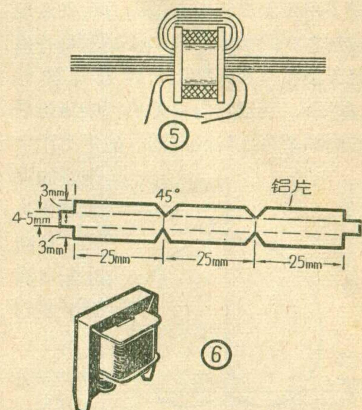
这样制成的输入和输出变压器，用在袖珍半导体收音机上效果很好。
