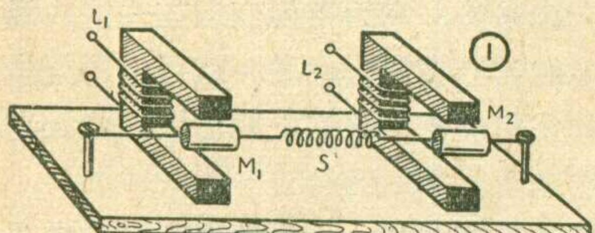
过繞在铁心上的繞組  $L_1$ ，因而在铁心間隙之間会产生和音频信号相似的交变磁场，这样就引起了小磁铁柱  $M_1$  的扭轉振动。螺旋弹簧  $S$  把  $M_1$  振动传递給小磁铁柱  $M_2$ ， $M_2$  也相应地振动起来，所以在  $L_2$  中就重新感应出音频信号来。由于  $M_2$  的振动時間要滞后于  $M_1$  的振动，同时机械振动的衰減也需要一段時間，因此  $L_2$  輸出的信号是一个延迟了并且逐渐衰減的信号。現在就是利用这个信号來模拟大厅中的交混回响效应。把这个
