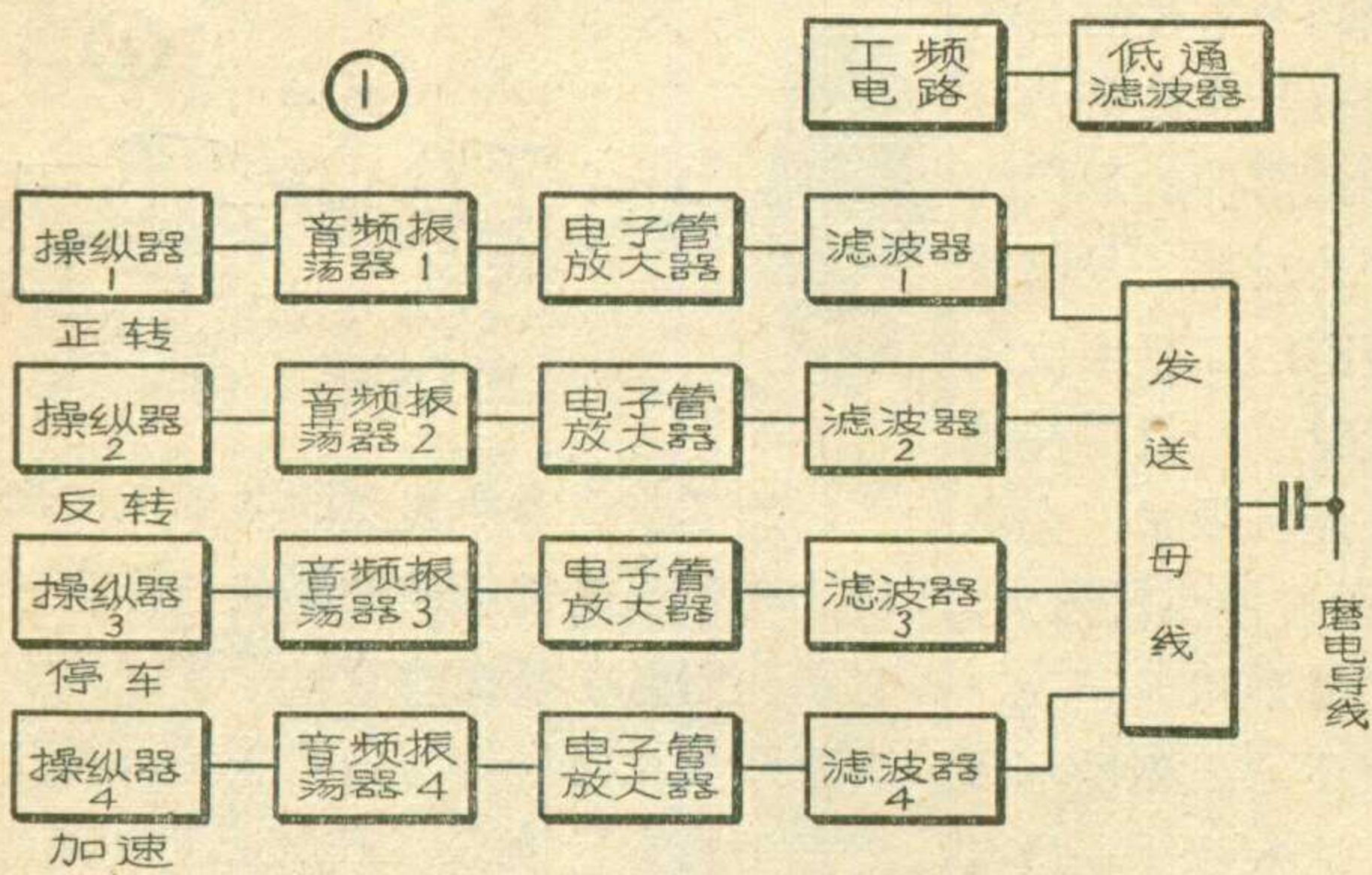
吊車上一般有大車、小車和卷揚等三台电机，为此，每台吊車应配备三套装置，分别向三条摩电导綫发送信号，控制相应的电机。
