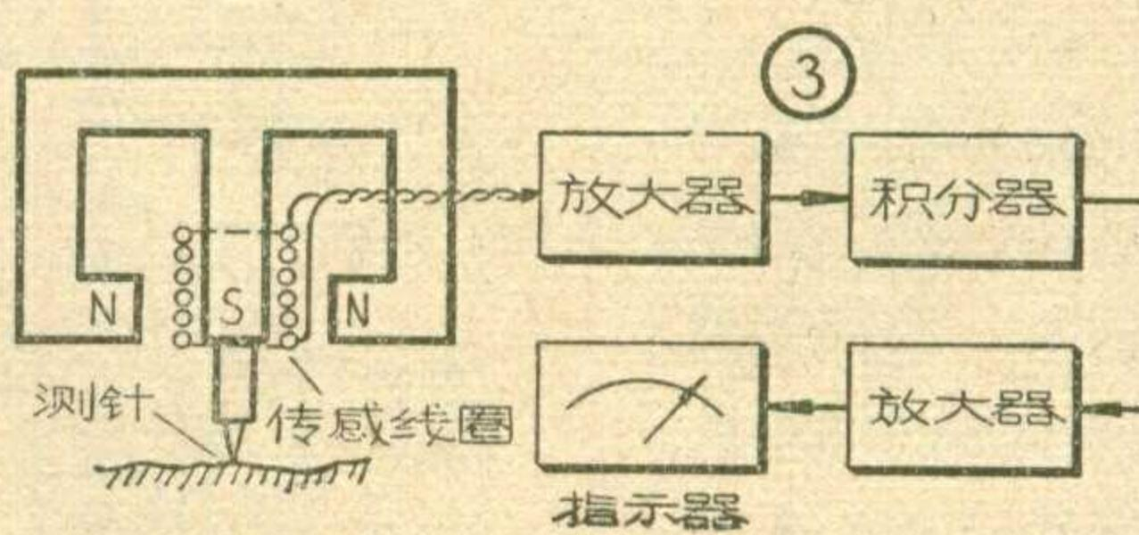
图。它的传感部分有些类似唱针做上下运动的电唱机。测针与零件表面相接触。整个测量头沿零件表面移动，此时测针将随着零件表面的坑坑洼洼作上下运动。从而使与测针相连的传感线圈在永久磁铁中运动。这样，在线圈的两端就产生一感应电动势。感应电动势的振幅与测针运动速度成正比，而持续时间与运动速度成反比。为了消除测针运动速度对测试结果的影响，为了使指示数值与测针位移成正比，经过一级放大后，把感应电动势送入积分器以后，就能得到与感应电动势振幅与持续时间的乘积成正比的信号，也就是与测针位移成比例的信号。由于积分器对信号有些衰减，所以经过二级放大后，再送入指示器。从指示器上可读出位移的算术平均值或最大高度。
