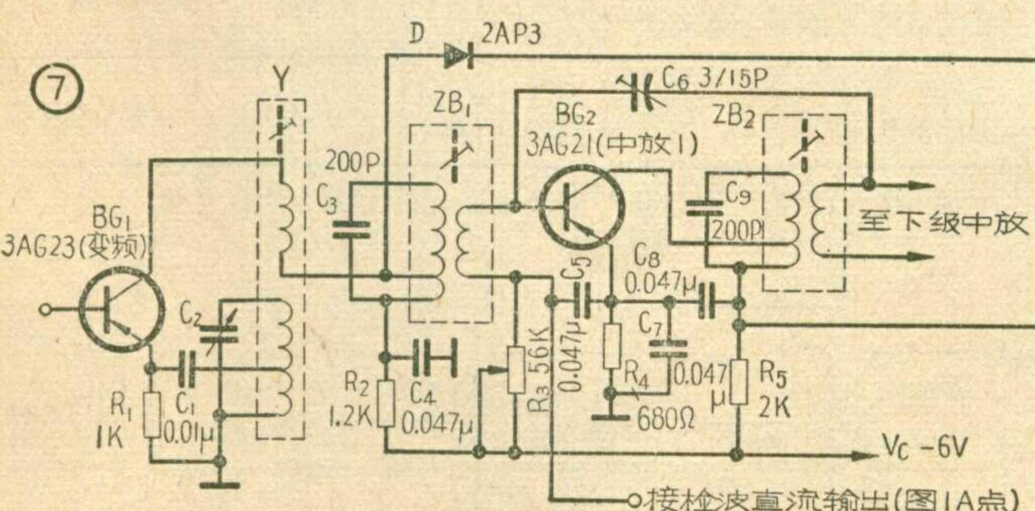
极管的内阻很小，对信号有较大的传输比，也就是经过  $C_1R_2$  输入的高频信号在  $D$  上降压很少，绝大部分降到  $R_3$  上，再通过  $C_2$  加到后面  $BG$  管去放大，这时  $D$  几乎等于短路，信号经过它受到的衰减很小。
