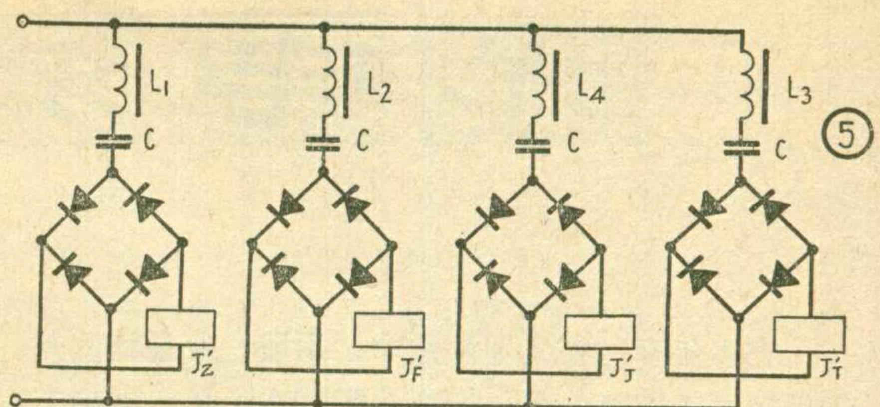
$J_z'$ : 加速和  $J_F'$ : 停车) 分别用来控制执行机构的相应中间继电器。
