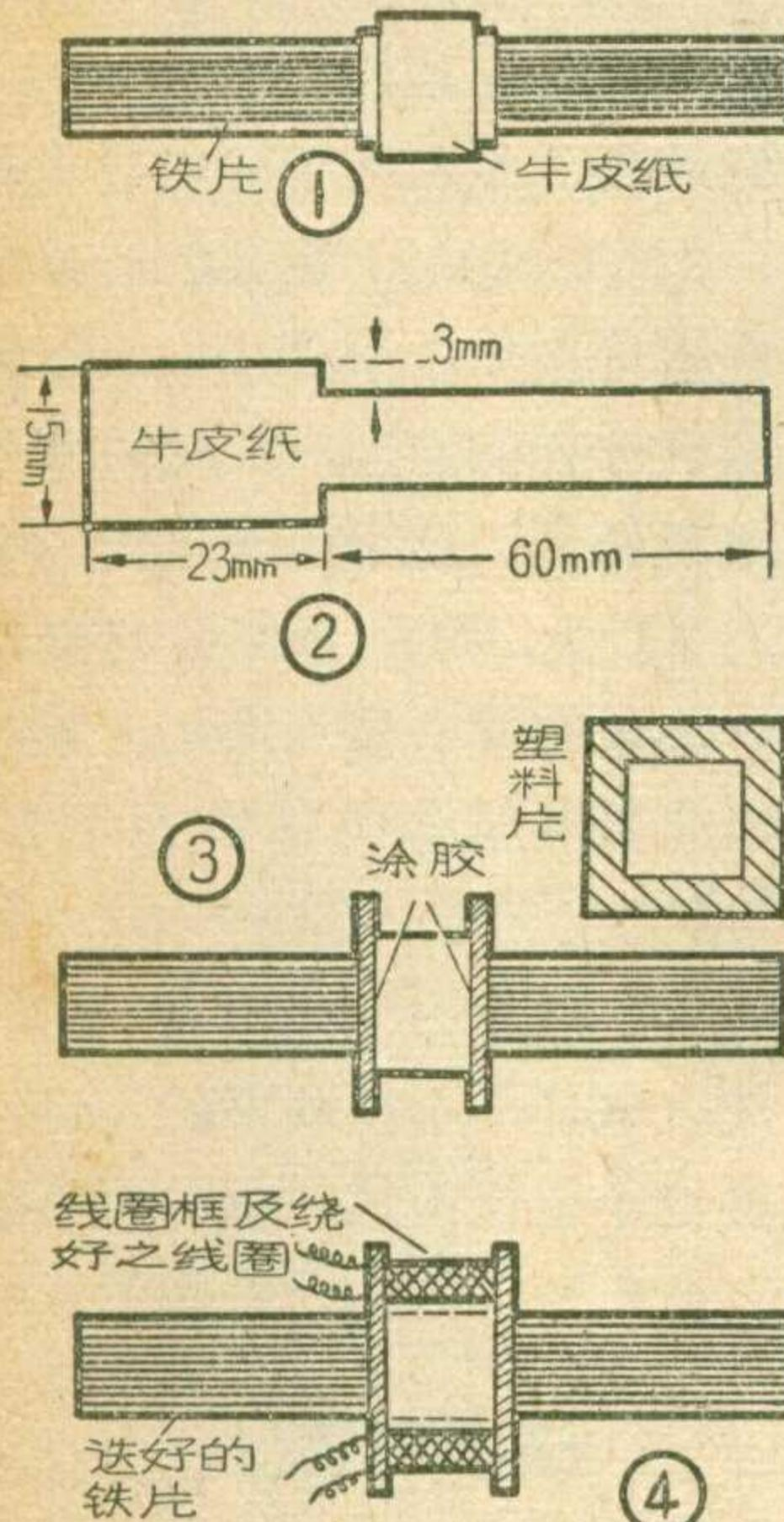
压器中的旧硅钢片（大型输出变压器或低频阻流圈中的铁心也可以），选用含硅少（即质较软）、铁片薄的，用剪刀剪成长约50毫米、宽约4~5毫米的长形小铁片20片，锤平后放入将熄灭的炉火中让铁片烧红，然后随炉火一块儿自然冷却。取出后每10片为一组，分成两组。每组可作一个输入或输出变压器的铁心。按图1把10片铁片迭齐，用预先剪好的牛皮纸条（见图2），宽头在里，把迭好的铁片紧紧裹上粘好，成为图1的形状。用中间方孔和铁心截面大小相同的两个塑料片，从两头套入（如图3），用胶粘好，即成线圈框。然后绕线，绕线的数据如附表。输入变压器先绕次级，后绕初级；输出变压器先绕初级，后绕次级。初、次级间要衬垫绝缘纸。绕制推挽式的有中心抽头的线
