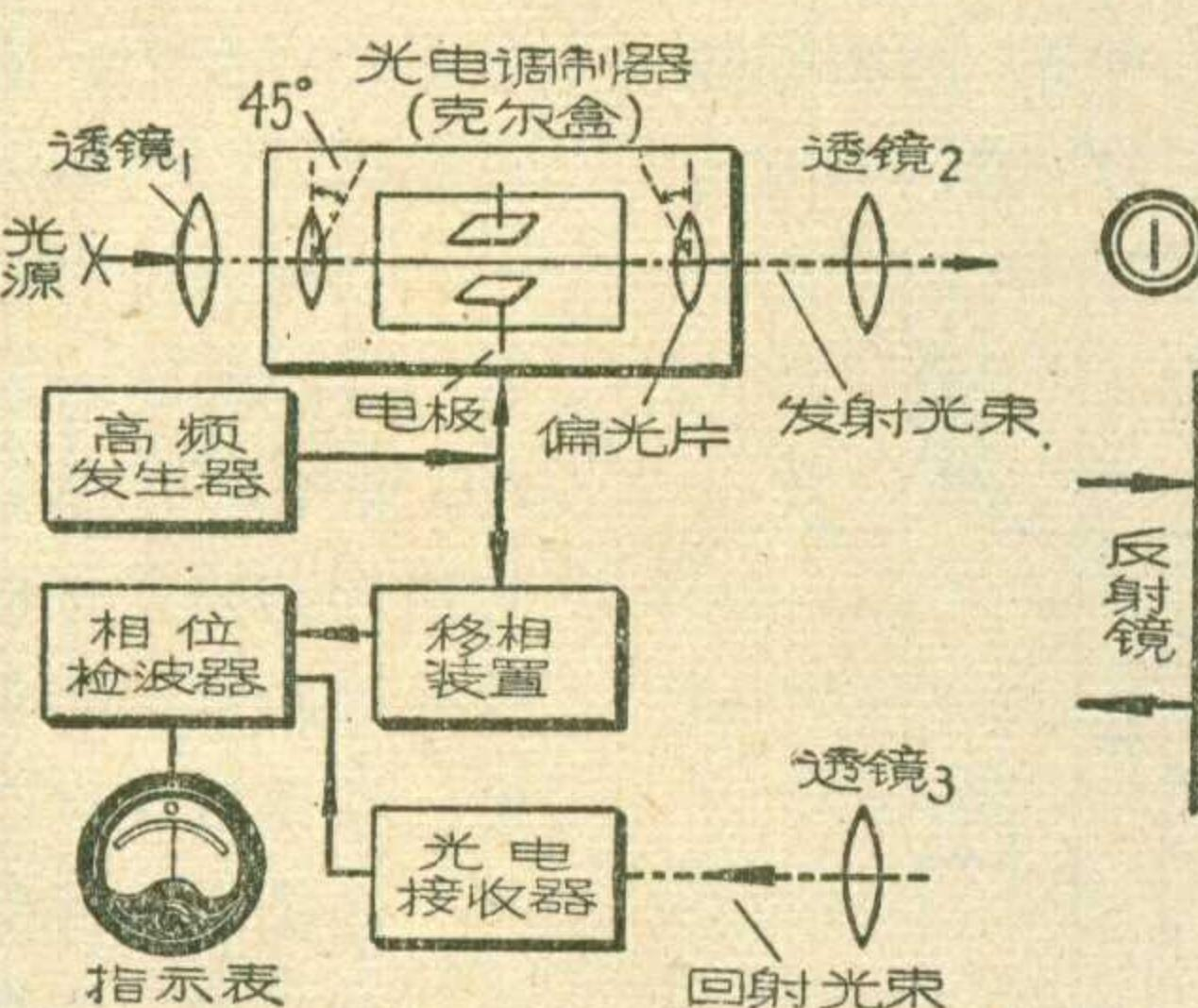
图1是光电测距仪的示意图。光源发出的光，經過透鏡1，被聚到电光調制器的中心。在电光調制器上，加有高頻发生器送来的高頻电压。在电压作用下，通过电光調制器的光束的亮度，被高頻电压所調制。透鏡2把光束变为平行光射向远方測点的反射鏡上。由反射鏡回射的光进入接收透鏡3，聚焦在光电接收器(光电倍增管)上。在这里，已調制光被还原成电信号，同时得到很高的放大，然后再进入测相装置(相位检波器)。
