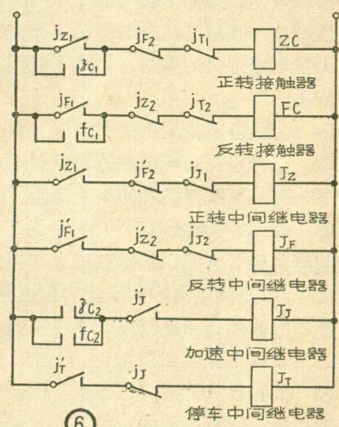
控制电机加速电阻。 $J_J$  的常闭接点  $j_{j1}$ ,  $j_{j2}$ ,  $j_{j3}$  分别切断  $J_z$ ,  $J_F$ ,  $J_T$  的电路，在电机加速运转期间，即使有它种信号输入，电路也不会动作。另外，电机在静止状态时，由于  $zc_2, fc_2$  常开接点切断  $J_J$  的励磁电路，即使  $j_J'$  闭合， $J_J$  也不会动作。也就是说，在电机静止时，即使输入加速信号，在执行机构里也不会有什么反应。
