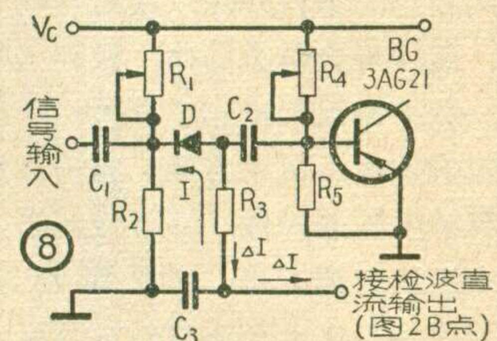
上是在原来的直流电路内加了一个极性与  $R_2$  上电压相反的电压，它加给控制二极管  $D$  的是反向电压。随着外来信号的增大，由检波直流输出电流所引起的这个反向电压越来越大，它抵消通过  $R_2$  供给的正向电压，使它降低。我们知道，二极管是一个非线性元件，随着外加正向电压的减低，它的内阻增大起来。将这种状态与前面的分析对比一下就可看出，输入信号将在它上面降压很多，而在  $R_3$  上降压很少，从而使信号受到很大衰减，使在强信号输入时，送到放大管  $BG$  的信号电压几乎仍保持不变，这就起到了自动增益控制作用。
