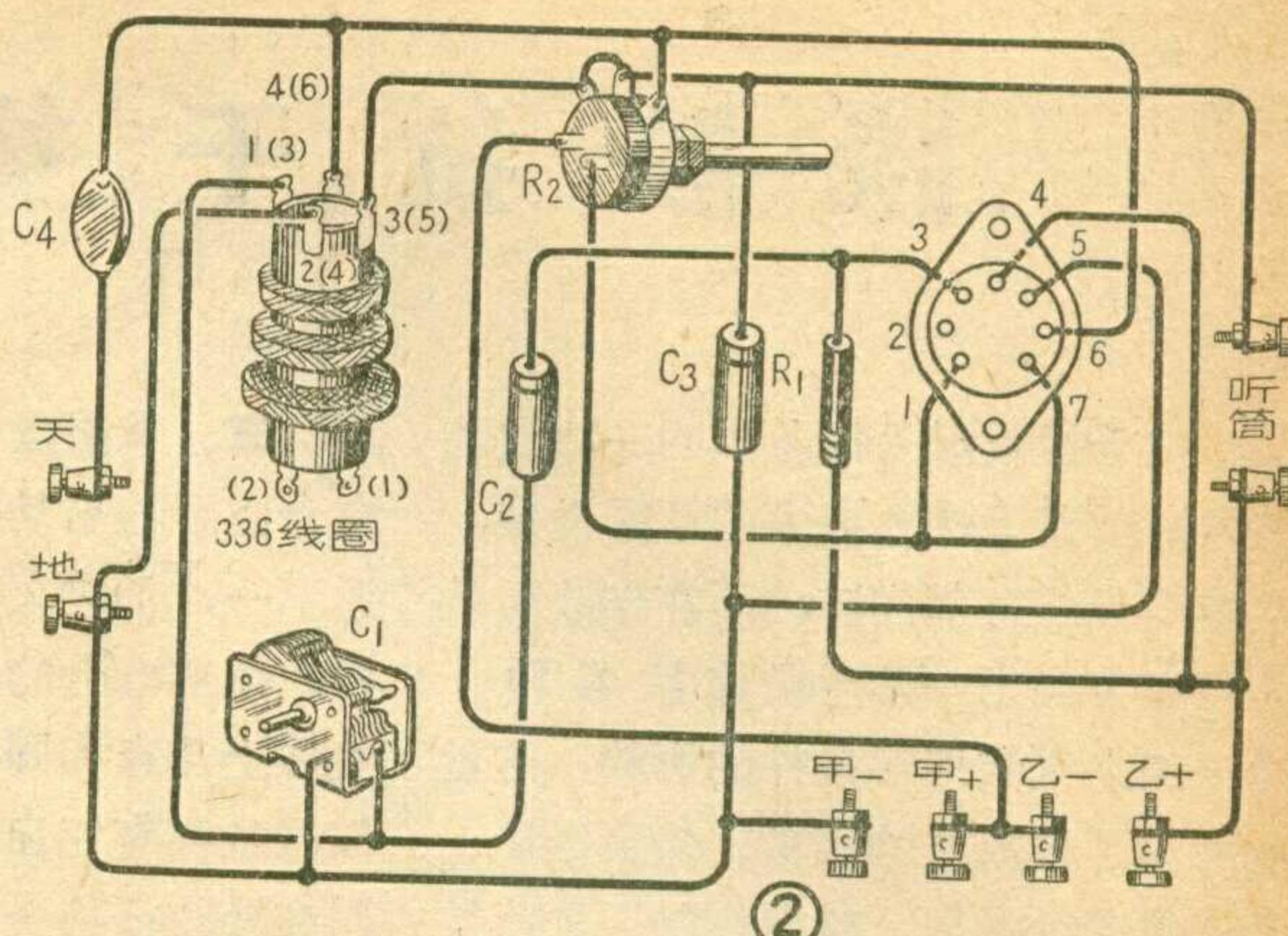
这架单管收音机的特点是成本低、效率高。用一对手电筒电池作乙电,能用两个月左右,非常省电。
