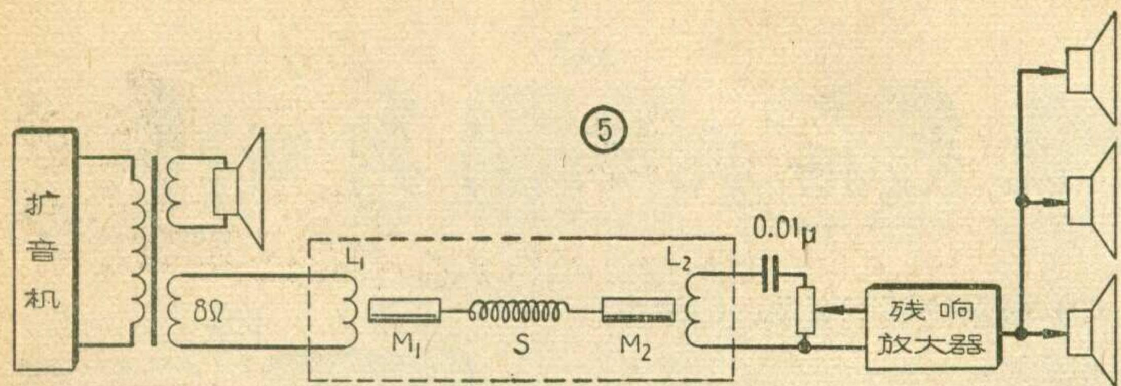
更滿意的接法是如图 5。在扩音机輸出变压器的次級加繞一組 8 欧的音圈繞組與  $L_1$  相連，而把  $L_2$  接到一台專為殘响放大而設的放大器上。殘响放大器电压放大的增益应在 60~80 分貝之間。如果  $L_2$  輸出很小，增益還要加大些。放大器的負載可由多只揚聲器組成，把它們安置在房間四角，聲音將更逼真。
