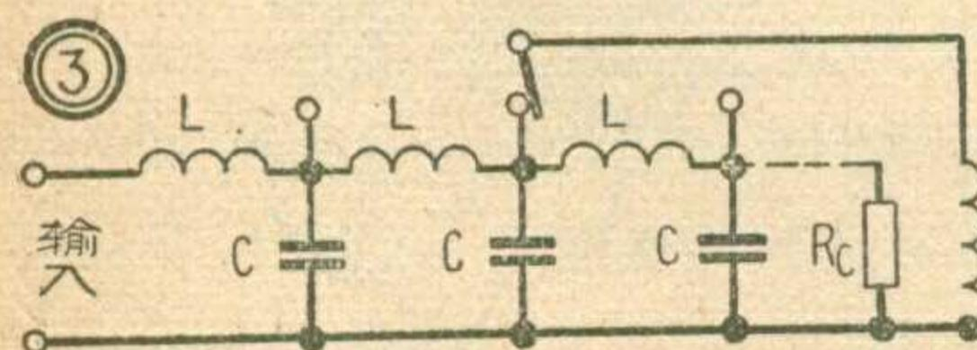
高頻移相器可以采用电阻一电容式的，也可以采用集总参数的延迟綫，后者的損耗較小，其电路如图 3。延迟綫电路，在形式上很像低通滤波器，它是由电感、电容組成的多級  $\pi$  形电路。在延迟綫的終端接有匹配負載，使輸入信号在終端沒有反射，形成純粹的行波。在延迟綫之后，接有諧振耦合回路，改变电容量就可以使輸出信号的相位作微量改变。利用这两种电路就能获得所需的任何相移。
