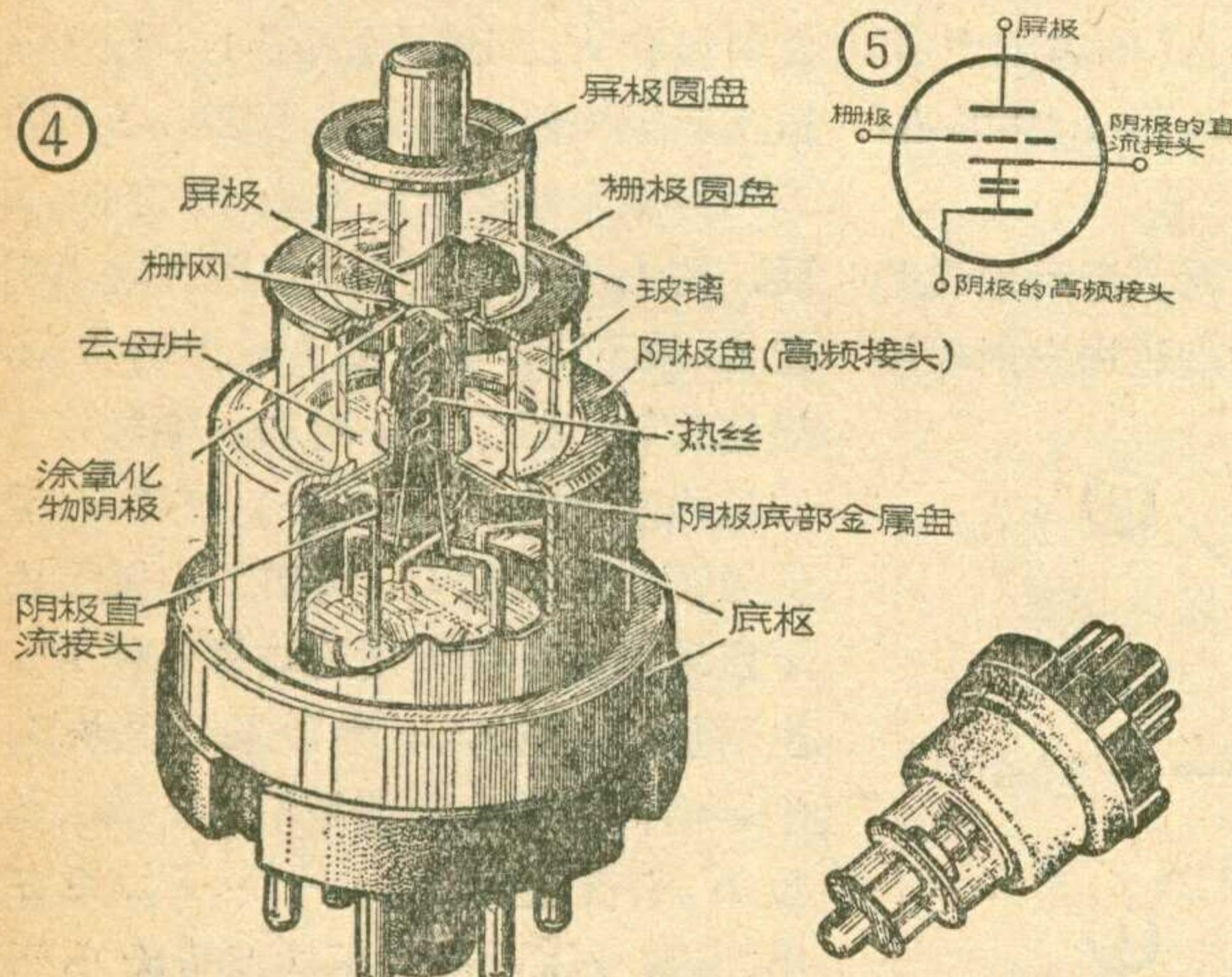
灯塔管就是圓盤形电极电子管的一种。图 4 是这种电子管的外形和結構。灯塔管由三个圓盤形电极組成，电极之間的距离很近，栅阴极間距离从 0.1 到 0.14 毫米，屏栅极間距离从 0.3 到 0.33 毫米。屏极是实心的金属圆柱体。阴极是空心的金属圆柱体，里面装有发热用的灯絲。用玻璃管把这两个圆柱体上下相对地固定在栅极圆盘上。栅极是用鎢絲編成的比屏极圆柱横截面积稍大的网子，并焊在一个金属圆盘的中央，形成一个中間有許多小孔的圆盘，用玻壳固定好以后，栅网就处在屏、阴极間的隙縫中。从阴极发射出来的电子必須穿越栅网并受它的电压变化的控制后才能到达屏极，于是屏流就出現随栅网上电压变动的交流成分，栅极起着和一般电子管相同的控制作用。
