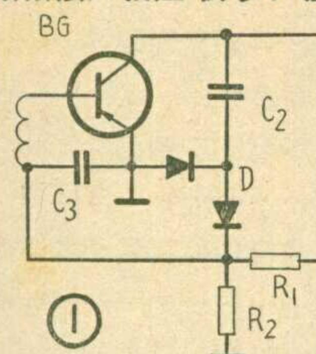
答：图中  $C_2$  以用 100 微微法較为合适。它在电路中的主要作用是将半导体管  $BG$  放大所得的高頻信号耦合到倍压检波器。但相反地，我們却不希望它将放大后的低頻信号再送到检波器上。100 微微法的电容在 1000 千赫处的容抗为 1.6 千欧左右，而倍压检波器的輸入阻抗(当  $R_2$  为 50 千欧时)約为 10 千欧，故对检波器的影响不大。但这时音頻信号却无法通过  $C_2$  再进入倍压检波器，因为 100 微微法在 2000 赫时的阻抗高达 800 千欧左右。如果換用 4700 微微法，这时对 2000 赫的音頻信号來說，阻抗降低为 16 千欧，就有可能使一部分音頻信号再整流进入半导体管，因而会产生反調制，加大信号的失真。
