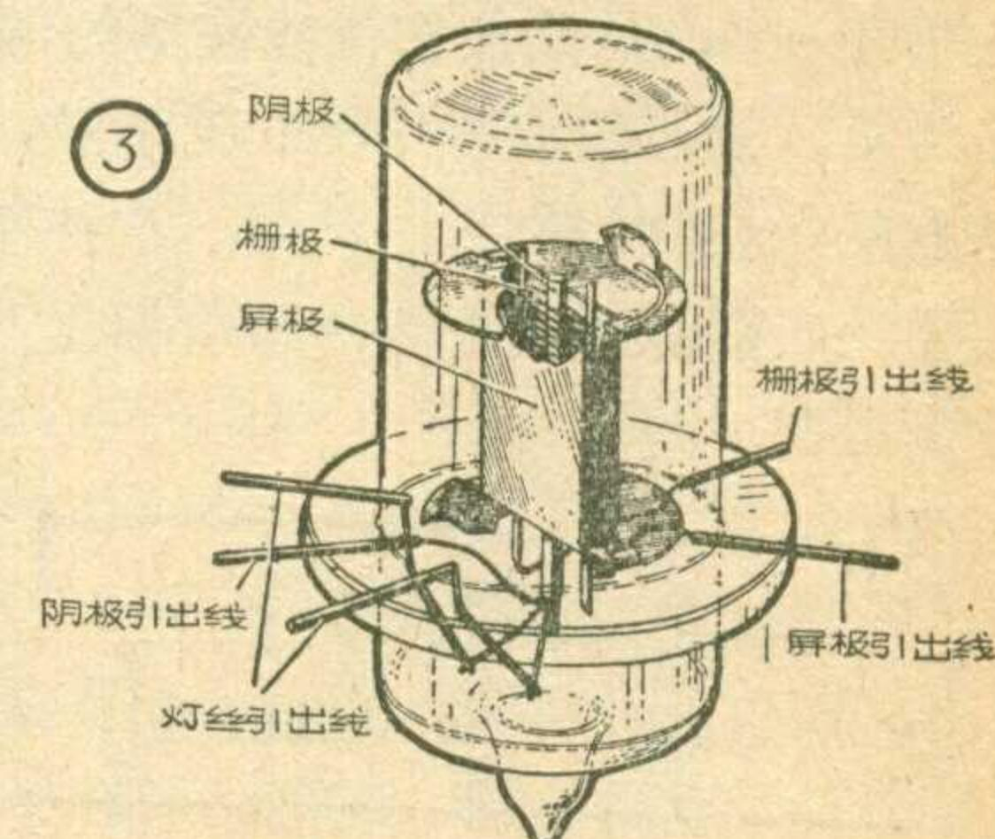
除了尺寸小和引綫短以及极間距离小以外，在結構上并无重大改革，因此已被目前广泛采用的圓盤形电极的电子管所代替。
