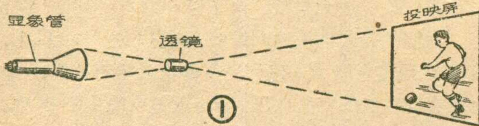
很大的图像。这种方法称为透镜式投映电视。使用这种方法的确把图像增大了，可是却大大降低了图像的亮度。这是因为：（1）显像管射出的光是向四外扩散的，只有一小部分射在透镜上得到利用；（2）透镜表面有反射，透镜本身也会吸收一部分光，因此射到透镜上的光又受到一次损失；（3）射在投映屏上的光，只有70~80%向观众反射回来。由于以上原因，透镜式投映电视只能利用显像管发出的光通量的 $1/10$ 到 $1/20$ ，而且由于投映屏上的图像比显像管上的大得多，所以投映屏上的亮度就很弱了。
