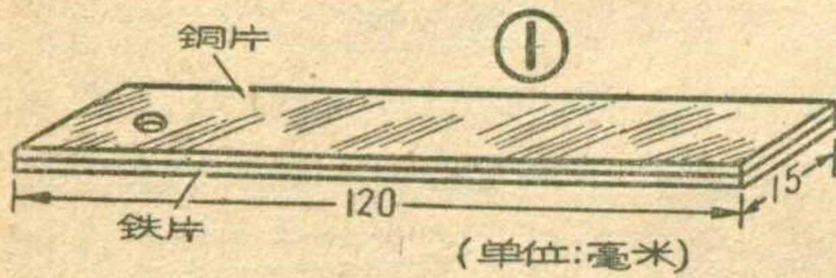
雙金屬片和燈泡按圖2電路連好，裝於發芽箱內。接通電源，閉合開關，燈泡發亮，箱內溫度逐步升高，雙金屬片也同時受熱。當溫度上升到一定程度時，雙金屬片就要向下彎曲，使接觸點脫開，切斷電源，燈泡熄滅，停止加熱，箱內溫度就會慢慢下降。
