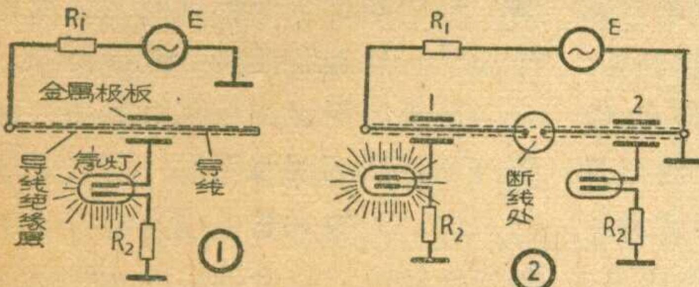
电容器。如果在金属筒和地之间串联一个氖灯和一个电阻 $R_2$ ，并把电纜芯线的一端与交流电源 $E$ 连接（电纜芯线的另一端空着），如图1所示，那么当芯线完好时，交流电就通过金属筒和导线组成的电容，使氖灯发光。图中的 $R_1$ 和 $R_2$ 都是限流电阻。
