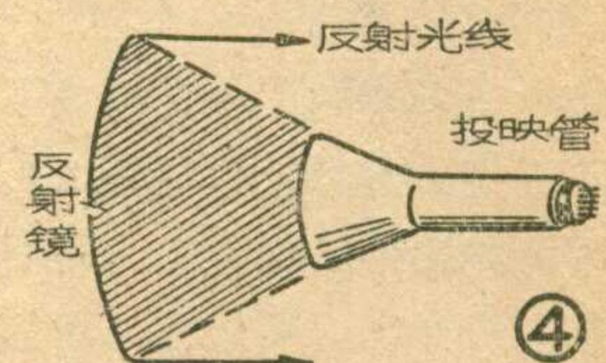
片的两个外表面上塗有半透明的银膜，它起电极的作用，交变电压就加在银膜上。银膜的外面盖上两块玻璃片。使用时，将光放大器放在投映管的前面。当投映管的荧光屏不发光时，光电导层的电阻很大（等于暗电阻），因此几乎全部电压都降落在光电导层上，荧光屏不发光。当投映管发光时，光电导层的电阻减小，结果电压在光电导层和荧光层之间重新分配，荧光层上加上较高的电压，因而便发光。荧光层上图像的亮度决定于加在半透明银膜上的交变电压的功率。光放大器与投映系统配合使用，便能得到巨大而明亮的电视图像。
