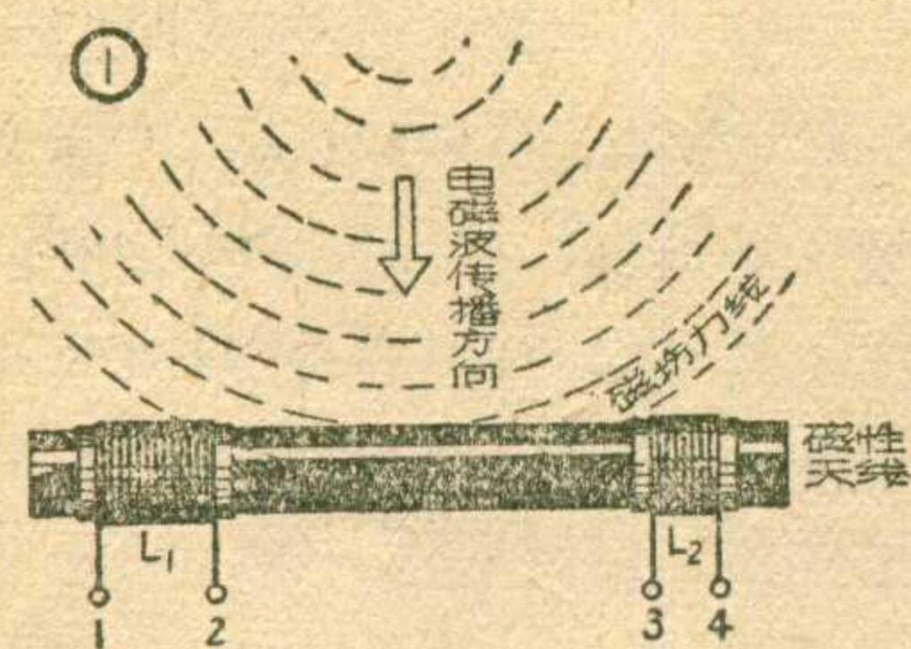
的电磁波集束地通过磁棒时，使繞在磁棒上的調諧線圈中能感应出較高的感应电压（比空心線圈大很多倍）。在調諧線圈 $L_1$ 中感应出来的信号电动势通过电磁感应传到耦合線圈 $L_2$ ，再送給輸入級（变頻或高放）半导体管。因此磁性天綫也起了輸入回路和第一級半导体管之間的耦合作用。
