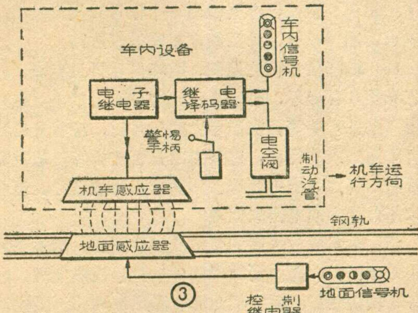
点式机車信号和自动停車装置的动作原理如图3所示。它不是用鋼軌来传递信号，而是由特設于某一点——进站信号机前方1200米处和400米处——的“地面感应器”来传递信号。当地面信号机为某一顏色时，利用控制继电器封閉地面感应器的某一諧振回路。当运行中的机車經過該点时，悬挂在机車上的机車感应器与地面感应器相互作用，而将信号传递到机車上去。然后由快速动作的电子继电器記錄下所接收到的信号，并把它送到譯碼器中，經過譯碼使机車信号显示出与地面相同的信号。
