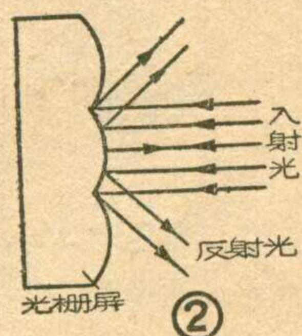
为使透镜式投映电视能实际使用，可用下述三种方法来增加投映屏上图像的亮度。
