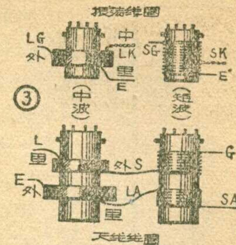
(6000PF) 接控制短路LG的一刀上（原刀上的接地线剪断），短波E'端接波段开关的另一刀上（见图2B）。这样当收音机工作于中波时，短波线圈未接入电路；当工作在短波时，由于短波线圈的线比较粗、圈数比较少，接入电路后并联接在中波线圈上将中波线圈短路，而且由于中波线圈的线比较细、圈数比较多所以对短波段影响不大，收听时还可以得到比较满意的效果。
