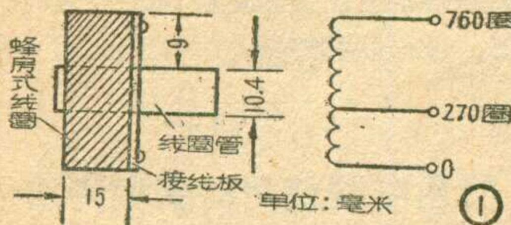
结构见图1，线圈额定电感量为6毫亨，损坏后（一般是内部霉断或短路）可以换用新线绕制。如无蜂房绕线机，可采用多层次叠绕的方式。绕制前在原线圈架上端加装上一块圆形厚铜纸板，与架上原接线板相距15毫米（图2）。线圈就逐层叠绕在这两块圆板之间的线圈管上。如用与原线相同的0.211毫米漆包线，需共绕875圈上下，于300圈附近处抽头。倘用0.31毫米（30号）漆包线，需绕748圈，于270圈左右抽头。线圈绕妥后最好浸煮凡立水或虫蜡，使它更为牢固耐用。重绕后的线圈，由于几何形状的变化和绕线疏密程度不同，电感量可能与原来有些出入，但实际应用问题不大。另外线圈用线不宜过细，否则不但易于霉损断路，而且会由于线圈直流电阻的增大，使线圈Q值降低，影响振荡效率。（庞炳根 朱剑和答）
