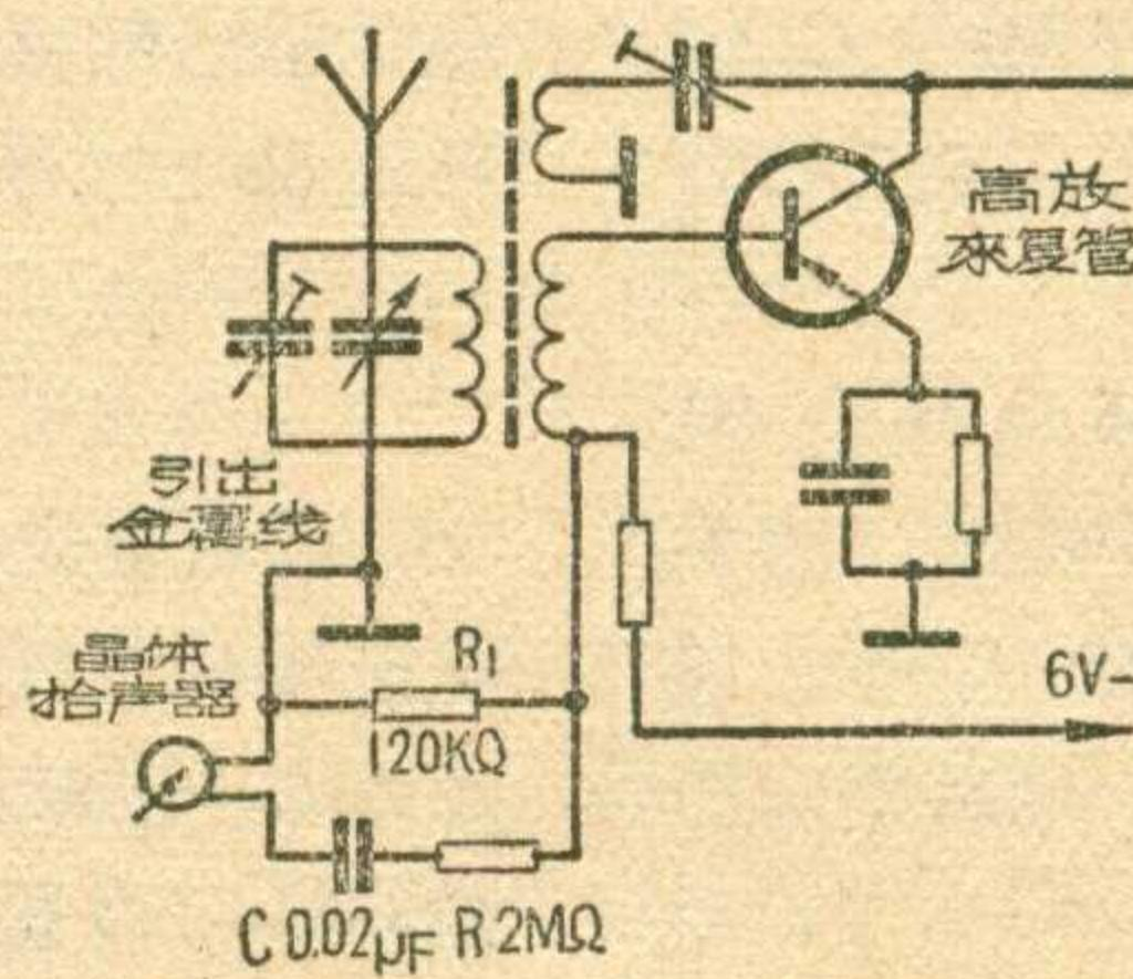
片音頻就經收音機的三級低頻放大，至揚聲器放音。晶體拾音器的輸出大小，可以由改變  $R$  的阻值來控制， $R$  的阻值愈小，拾音器的輸出愈大，應適當調整，以輸出信號不失真為合度。對於音調，可以改變  $C$  的容量來控制， $C$  值愈大，高音衰減愈多，隨之低音也愈豐富。
