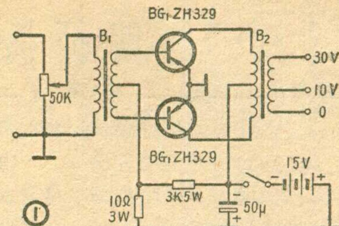
器为了适应不同线路和负载的需要，采用多头式输出，铁心截面积3.0平方厘米，初级用0.27毫米(32号)漆包线绕480圈，在240圈抽头，次级用0.51毫米(25号)漆包线绕240圈，在120圈抽头(图2乙)。
