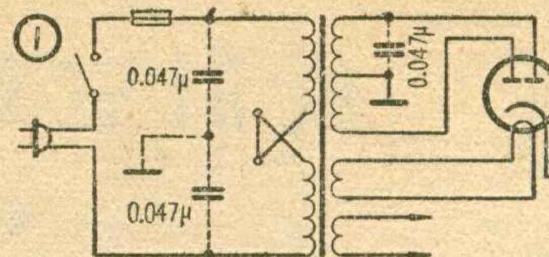
线的接地点和电源变压器的高压中心抽头引出线，以及滤波电容器负极接地线等，共同汇集在一个地线焊点上。在电源变压器的初级，在电源进线之间串联加接两只0.047微法、耐压600伏以上的电容器，中心通地，或在变压器次级高压线圈通整流管屏极的一端上加接一只同上的电容器（图1），可以有效地改善由于线路上和机件排列方面所产生的调制交流声。
