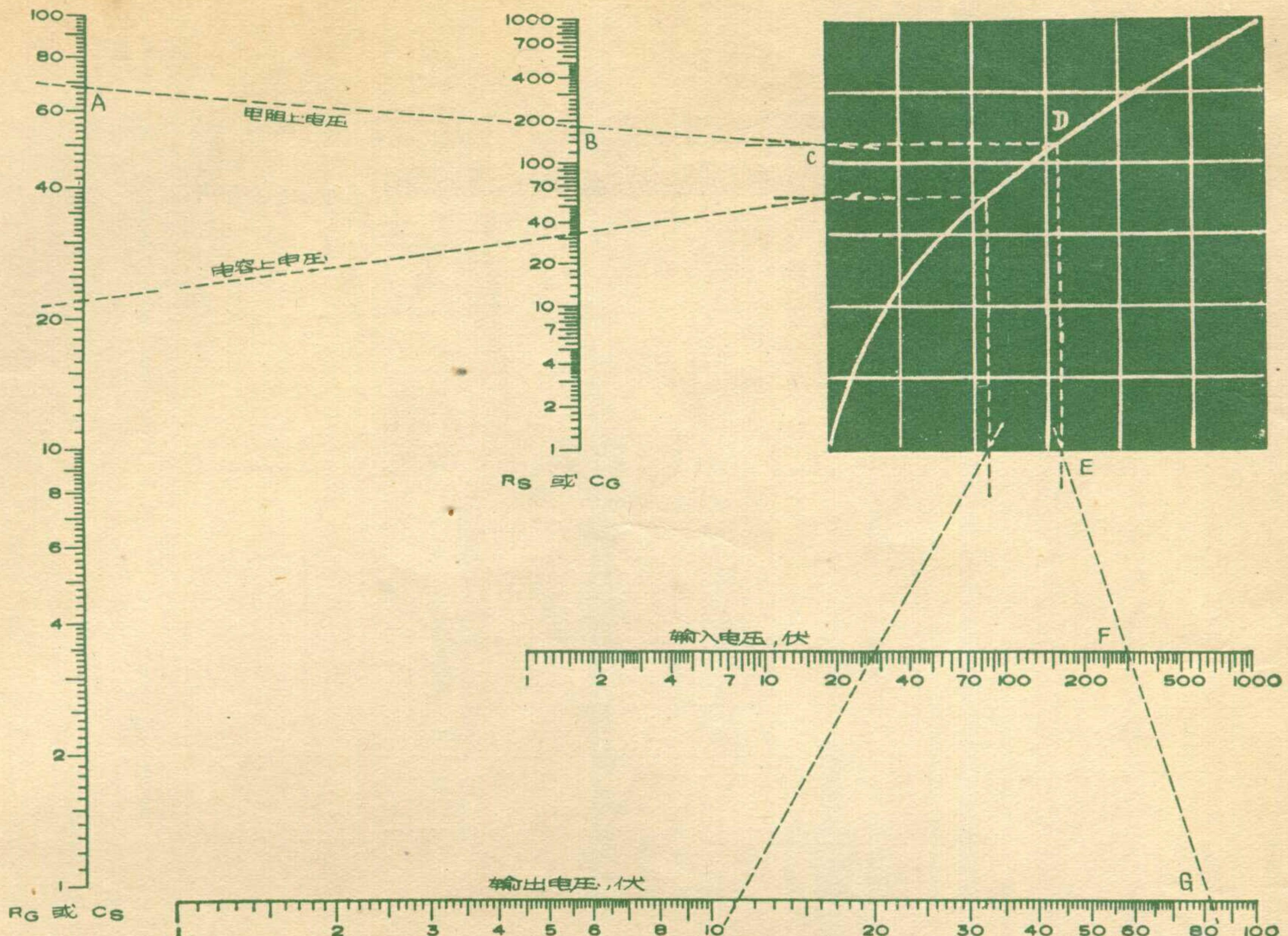
在图示电阻分压器或电容分压器中，当跨接整个分压器的输入电压和组成分压器的元件数值已知时，利用这种计算图可以求出跨接其中一个元件的输出电压；或在输入电压、输出电压已知的情况下求出各组成元件的数值。
