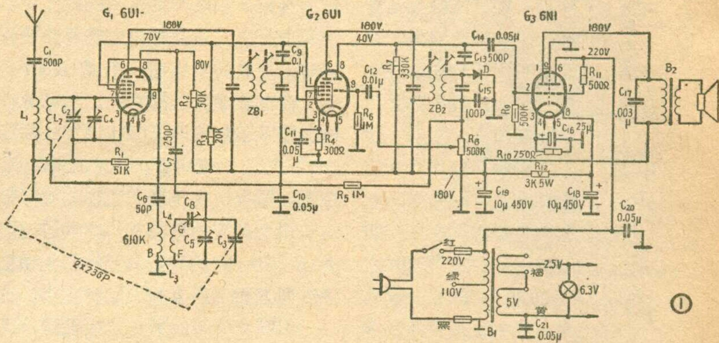
电子管也是6U1，一管两用，七极部分担任中放，三极部分作为低頻电压放大。檢波和自动增益控制用半导体二极管，取其体积小，可以代替和减少一只电子管的地位和电源消耗。最后的功率放大級和电源整流合用一只双三极管6N1。所以，全机虽然只有三只电子管，电路功能却和完善的五灯机一样。
