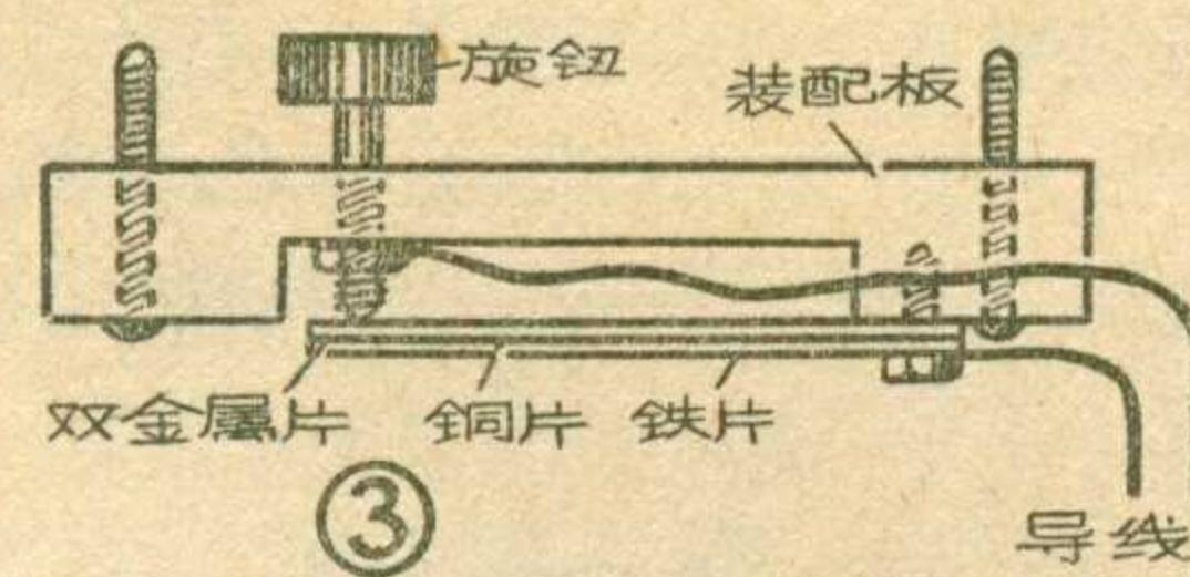
於保溫。雙金屬片要裝在一個裝配板上（見圖3），並將裝配板釘於發芽箱內頂部。控制旋鈕裝在箱頂外面（注意絕緣），便於調節。燈泡裝在箱底（參看圖4）。
