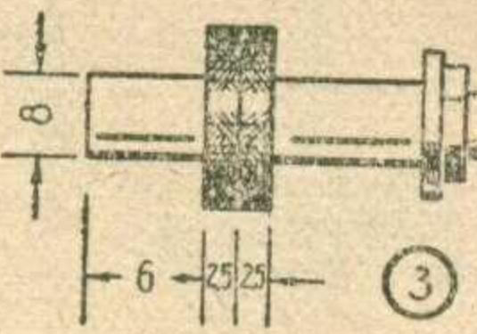
2. 高频扼流圈：见图 3。高频扼流圈在  $\phi 8$  的塑胶管上，用 0.12 毫米
