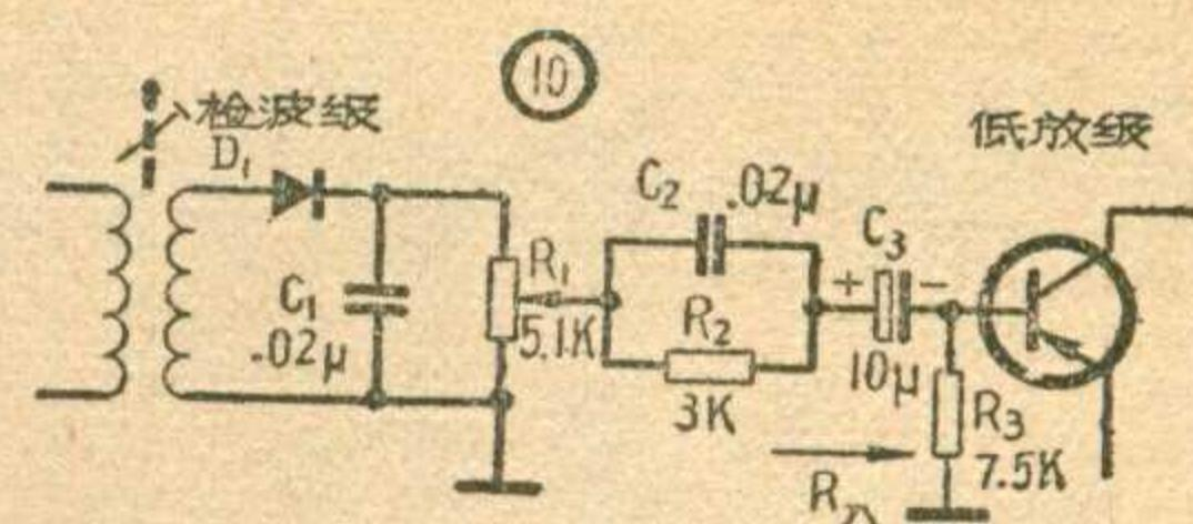
收音机要传递的音频频率范围内，阻容耦合放大器就可以近似地看为一个全是电阻的电路（对信号而言），因此它的频率特性是很均匀的，信号的失真比較小。所以频率范围較寬和频率特性較好是阻容耦合放大器的优点。此外，这种耦合电路比变压器耦合电路结构簡單，元件比較便宜。
