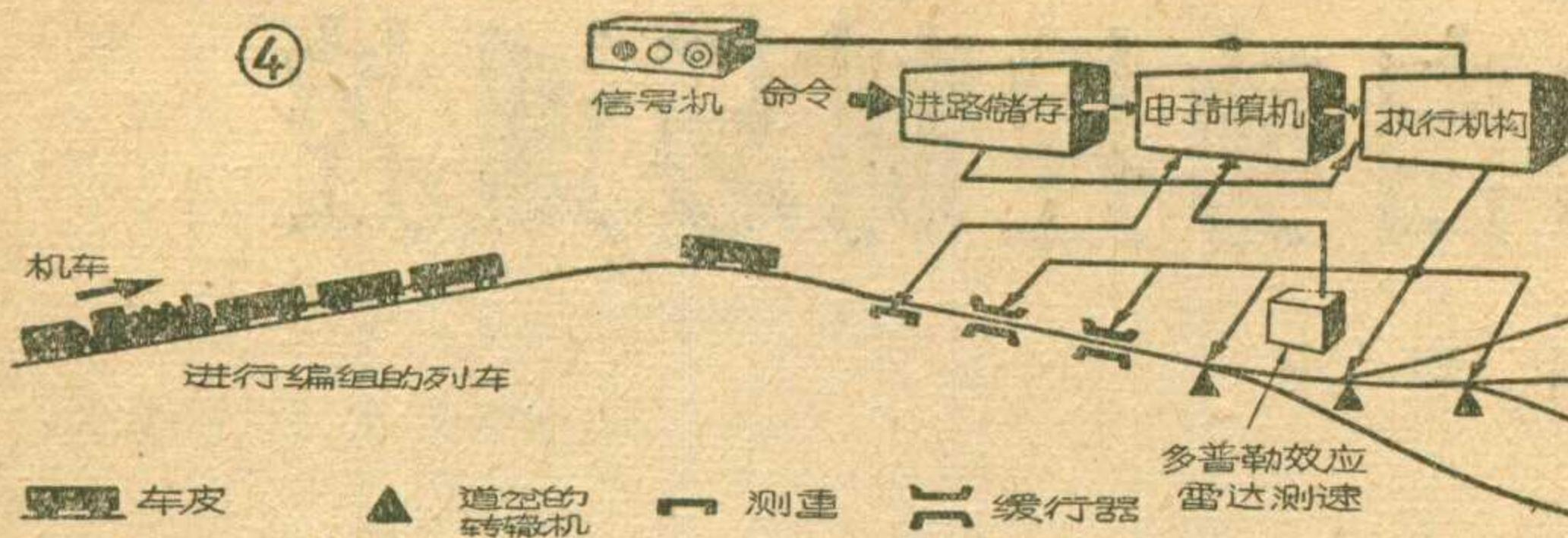
地装卸的车辆，组成驶向不同方向的列车。一个大的编组车站一天要编几千辆车。过去多半是用机车分别从各个线路上将车辆拖出来，再送到另一条编组线路上去，这样效率是很低的，并且需要很多辆机车同时工作。
