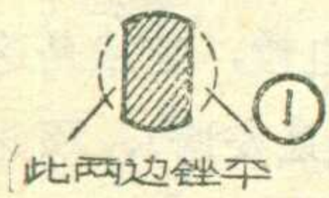
调谐电容器 旋柄断面
