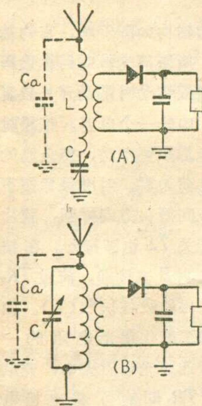
若綫圈  $L$  的电感在图A中配合得是正确的，正好能接收整个中波电台的話，那么，将  $L$  不加修改的接成图B，就显得电感太大，频率較高的电台都被移到調諧回路的諧振频率范围以外而听不到了，这时应将綫圈圈数减少一些。
