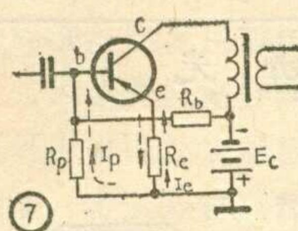
最常用的 是图7所示電路。其中多了一个电阻  $R_p$ 。电源  $E_c$  加到  $R_p$  和  $R_b$  組成的分压器上,  $R_p$  上的电压降經過  $R_e$  加到  $e$ 、 $b$  两极之間, 作为发射結的偏压。偏压的大小主要决定于  $R_b$  和  $R_p$  的分压比例。集电結所需的负偏压則是由电源  $E_c$  經過  $R_e$  和变压器初級圈加上去的。有了  $R_p$  之后就在基极和发射极間构成一个回路, 于是电压  $R_e I_e$  就起等效于电源的作用, 使回路中形成一个电流  $I_p$ ,  $I_p$  的方向和基极的偏流方向相反, 起抵消偏流的作用。当  $I_e$  因  $I_c$  增大而增大时,  $R_e I_e$  增大,  $I_p$  也增大, 抵制偏流的增加, 从而使集电极电流穩定下来。所以  $R_e$  和  $R_p$  的共同作用使电路的溫度稳定性提高。显然  $R_e$  愈大和  $R_p$  愈小, 稳定性愈高。在这种电路中偏压和稳定性可以分別单独控制。
