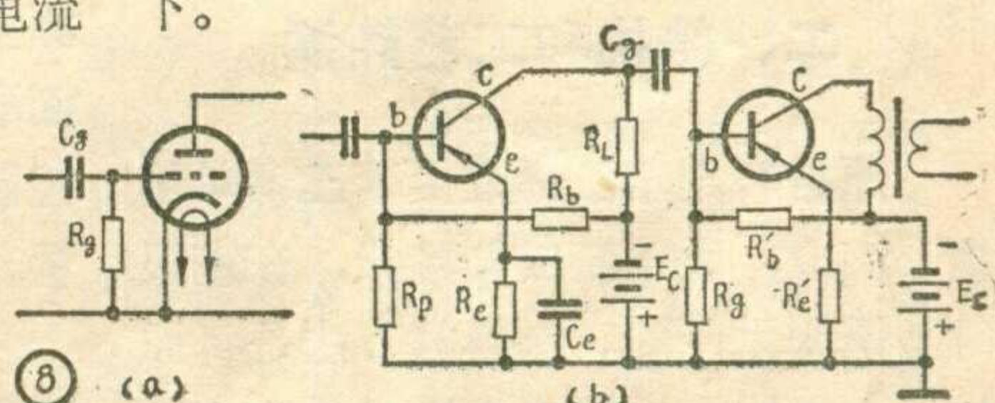
半导体管放大器的发射結加有正向偏压, 基极电流有一定的大小, 所以它的輸入电阻很低(只有几百欧姆一般不超过  $1K$ ), 这种工作与无栅流状态的电子管放大器(图8a)大不相同, 后者的輸入电阻大到兆欧的数量級, 可以視為开路而不予考虑, 因而它的栅漏电阻  $R_g$  也用的很大( $500K$ 左右)。 $C_g$  和  $R_g$  对信号电压是串联的, 当  $C_g$  的容抗( $\frac{1}{2\pi f C_g}$ )和  $R_g$  的阻抗相比很小时, 信号电压的绝大部分降落在  $R_g$  上, 耦合到下一級去,
