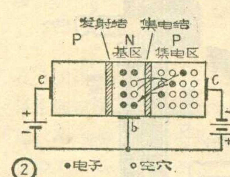
子管的陰極電流）、基極電流 $I_b$ （相當於柵流）和集電極電流 $I_c$ （相當於板流）。集電極電流包括兩個部分：一部分是由於發射結的注入而形成的電流；還有一部分是無法避免的電流，叫做集電極反向飽和電流 $I_{co}$ ，它是由於集電結所加反向偏壓的作用而形成的。參看圖2，由於基區和集電區之間的集電結兩邊加有很高的反向偏壓，基區和集電區的多數載流子（電子和空穴）無法越過集電結而形成電流，但這兩區的少數載流子所帶電荷極性剛好和多數載流子相反，在反向偏壓吸引下剛好能促使它們分別向不同方向擴散，如圖中箭頭所示，從而形成了電流。習慣上認為電流方向與電子運動方向相反，所以由於反向偏壓作用而形成的反向飽和電流，其方向是由基極 $b$ 流到集電極 $c$ 。在一定的溫度下，少數載流子的數目是一定的，擴散到一定程度不再增加而使電流趨向飽和，所以稱這種電流為飽和電流。
