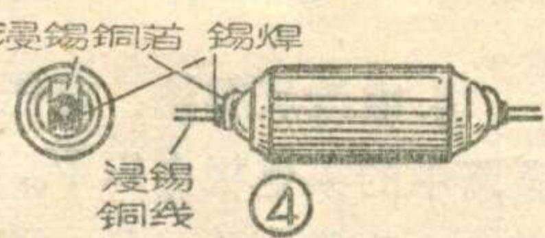
电容量和其他性能发生变化，所以要求焊接时尽量迅速，一般规定焊接时间不超过10秒，并规定焊接处与电容器端面的最近距离，必要时还应采用热屏蔽，以便薄膜少受到烙铁热量的影响。
