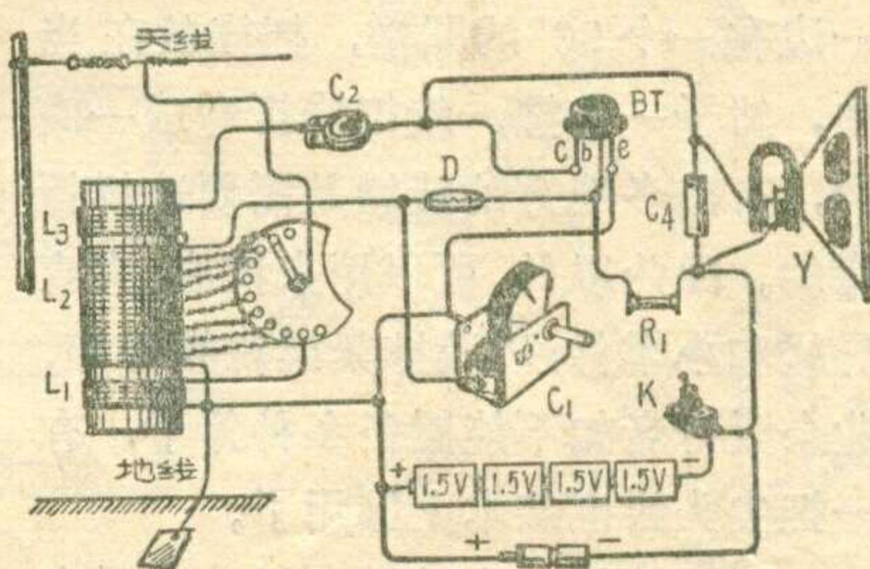
避免电源的电压降低时收音机产生叫噪。如果扬声器改用永磁或恒磁电动式的，就需要添加一个输出变压器，可以购买售品或参考本期有关文章自行绕制，这时声音可好听些。
