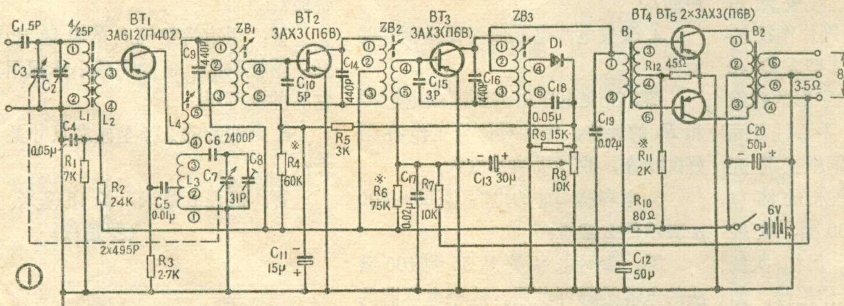
里。第二級中放管( $BT_3$ )担任中頻及低頻放大工作，对全机的性能影响較大，应当选用 $\beta$ 值較大的管子。推挽放大的两只管子參量应当相近，这样可减小靜态工作电流及失真程度。
