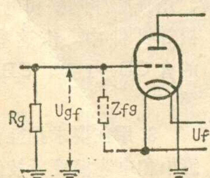
电流 175 毫安，屏流仅 4 毫安，所以加在任何交流收音机上都沒有問題。灯絲和  $B+$  电源都是利用插脚接綫从放音的收音机上接过来的。
