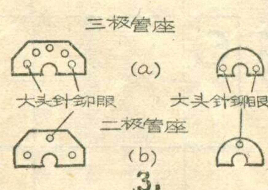
找一种胶木的小型电子管的插座。第一步用起子把中心铆钉撬开，把插座底的圆托片打开，各插脚焊片自然脱落（见图 1）。
