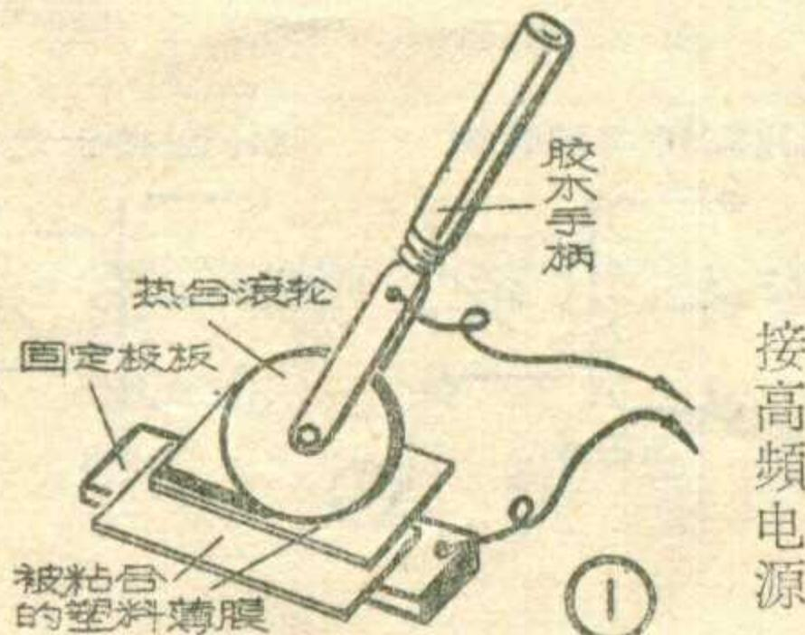
曾把8层0.2毫米厚的聚氯乙烯薄膜一次“縫”合起来和把两层将近1毫米厚的聚氯乙烯人造革“縫”合起来。
