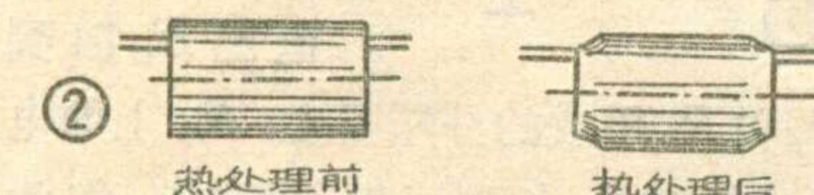
遇热成塑性状态，在电容器两端熔缩成一整体（见图2），这样可起防潮作用，并增强了电容器的机械强度。为了提高电容量的稳定性，还经过温度老炼工艺，加温到摄氏六、七十度，每次老炼一、二小时，重复几次。经过上述几个工序，就制成了薄膜电容器。
