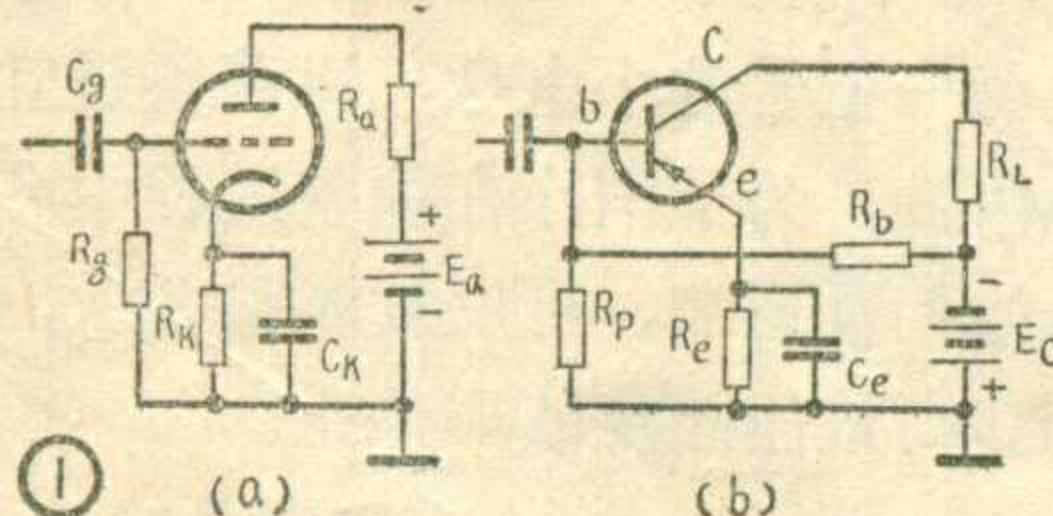
$$E_c = V_{ce} + I_c R_L$$
