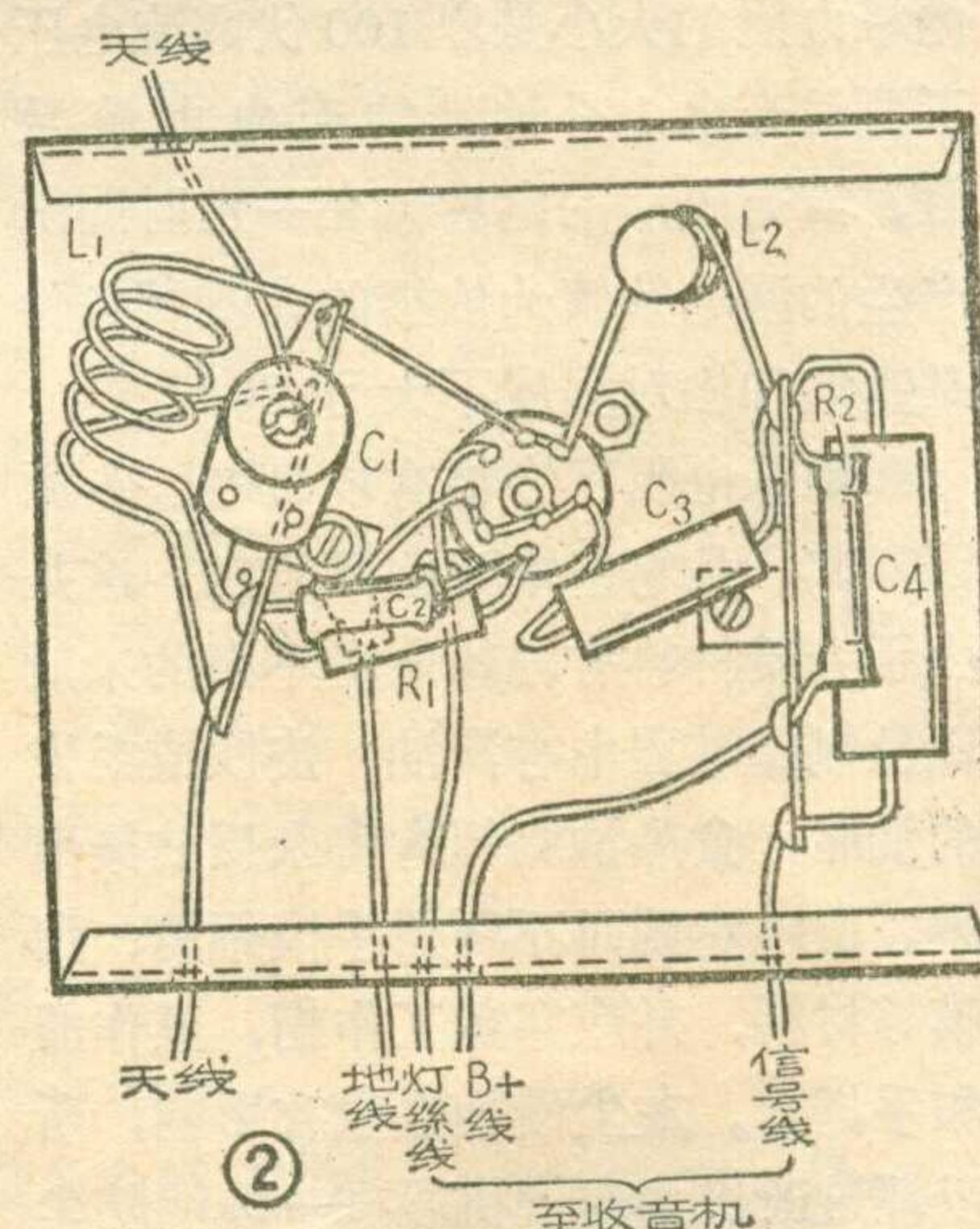
一般电子管栅极与灯絲引出綫要尽量隔开。在有些綫路里，灯絲电压是一端接地的，这时对漏阻抗  $Z_{fg}$  要求就更高。
