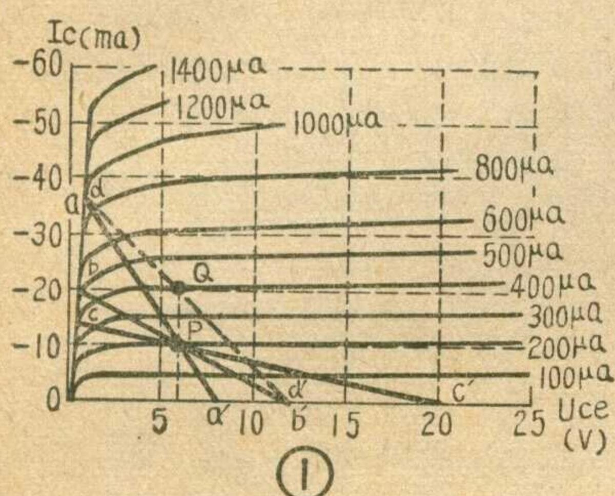
种。而晶体管的最佳负载阻抗却与工作状态密切有关，虽然用的是同一型号的晶体管，但只要工作状态改变以后，最佳负载就会改变。如果用了一个不是最佳负载的
