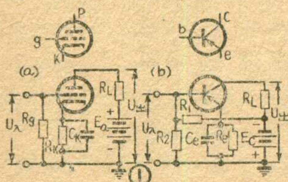
与阴极之間，以阴极作为衡量輸入、輸出电压的公共端点。平常說輸入电压或输出电压是多少，都是指对阴极來說的。在图1(b)中，輸
