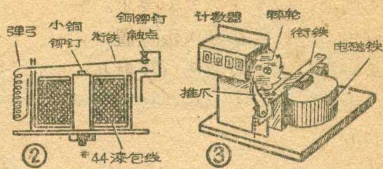
3千欧的直流继电器。我們是用一个旧汽車充电继电器改制的，只要拆去原線圈，改用44号漆包線繞滿为止。銜鐵用0.5毫米厚的硅鋼片剪制，在銜鐵一端鉚一小銅鉚釘作觸點，在鐵心上也鉚一小銅鉚釘防止銜鐵吸住。改装后如图2所示。
