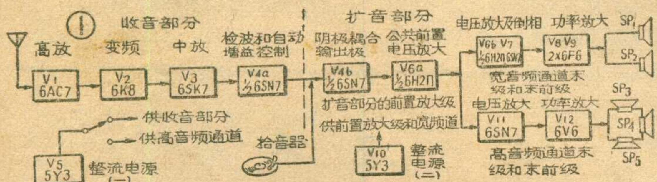
失真等，使音质更优美动听。通过变换开关接点，可单独使用宽频道，或同时使用两个频道扩音，也可把宽频道改成为低音频通道与高频道组成双频道放大器，以满足不同的放音（音乐或戏曲等）要求。
