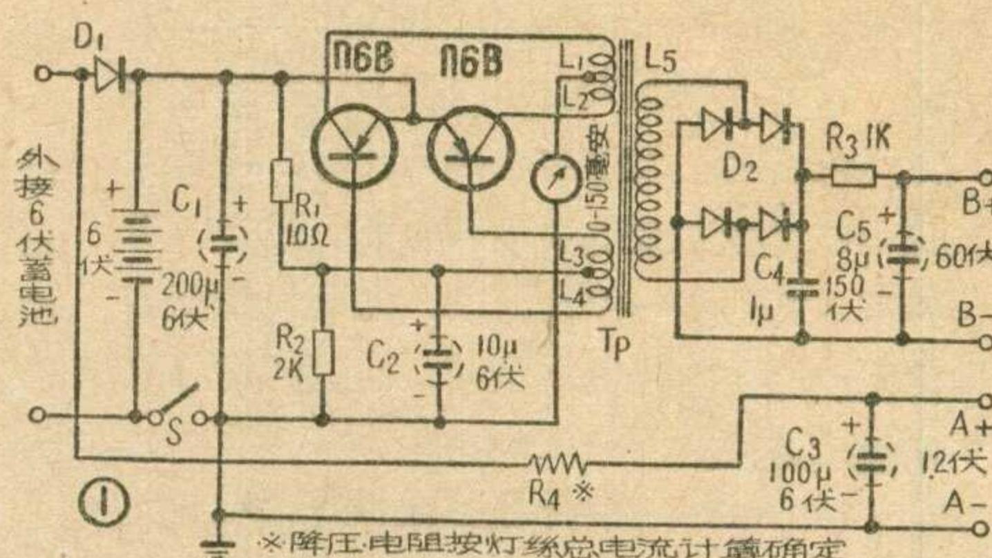
方法繞31圈作L<sub>3</sub>和L<sub>4</sub>。以后再在L<sub>3</sub>和L<sub>4</sub>上包一层黃蜡綢，用0.12(#40)漆包線繞2600圈作为L<sub>5</sub>，铁心的插法与电源变压器一样，系交叉插入，不需要留空气隙。最后把整个变压器浸在热蜡里处理，驅除潮湿。
