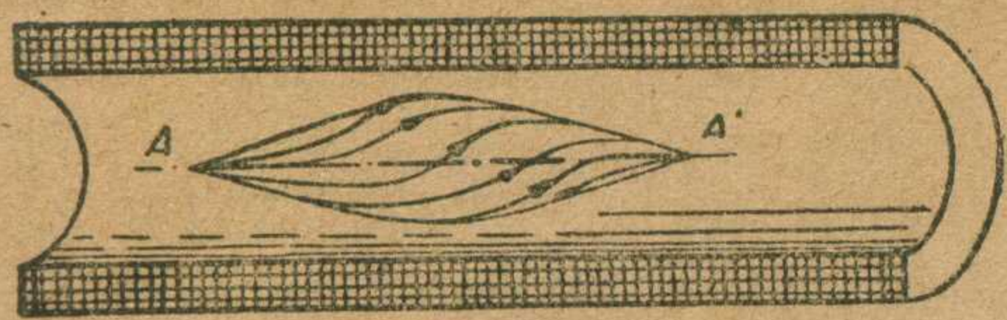
图1. 长电磁透镜和光学透镜的对比。 A—物点， A'—象点。
