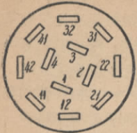
这是波段开关底视图所标之号码为相应之接綫 (見圖 14) 圖 17 波段开关接綫圖
