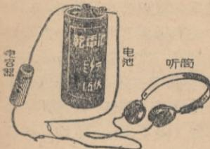
圖 7 用听筒試驗紙電容器
