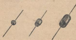
圖4 干式鉛極电解質电容器
