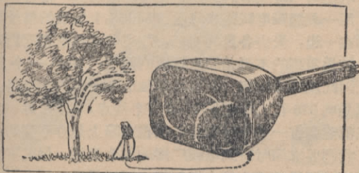
用電視攝像管來探測示蹤原子所發生的 \gamma 射線，一次就可以把全部示蹤原子的位置決定下來。
