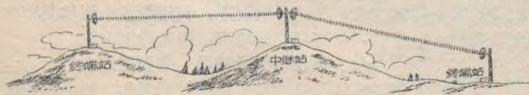
圖4 用RVG903D建立長途接力通信的示意圖
