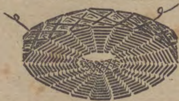
圖 10 通用繞組式扼流圈（交叉繞法）
