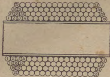
圖 8 分佈電容量最大的一種多層扼流圈
