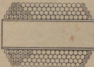
圖 9 多層扼流圈很不實際的繞法
