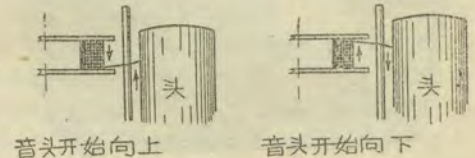
圖 6 排絲柱給鋼絲增加了阻力。
