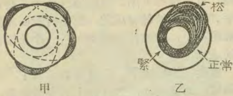
圖 4 甲 供絲盤軸孔太大，向四週攙動，倒成的供絲盤。
