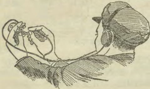
圖6 試驗耳机好坏的最簡單方法。
