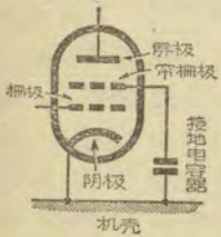
圖6 簾柵極有隔离作用，因为它是經電容器接机壳的
