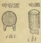
圖4 插塞式零件 a—扁圓形 b—圓柱形
