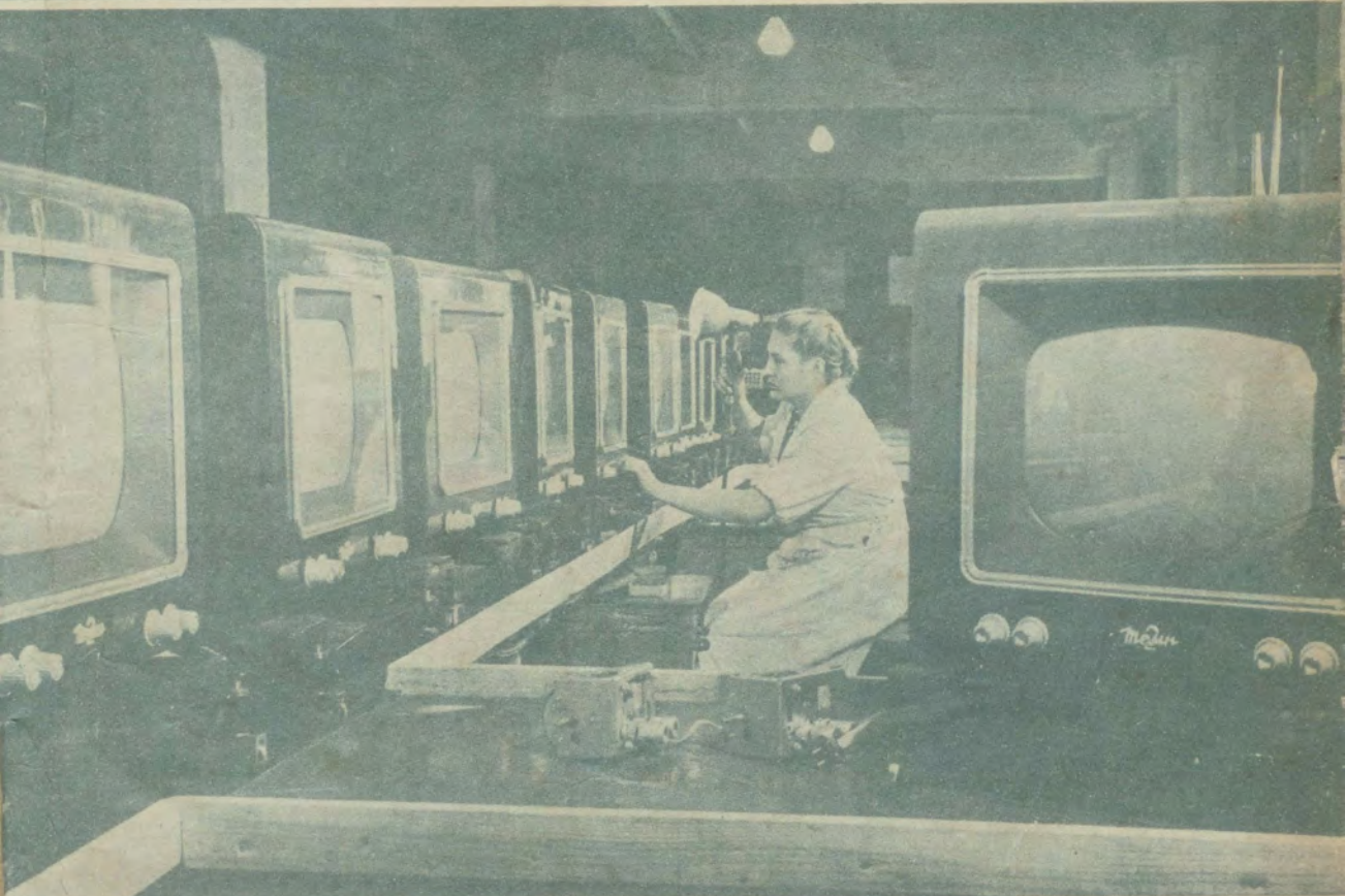
莫斯科無線電工廠製造的新式“Тем-2”型電視接收機，可以接收五個電視廣播台和三個調頻廣播台。 上圖：裝配工人正在裝置這種電視接收機的情形。 下圖：技術員正在技術檢查部檢查電視接收機。（塔斯社）
