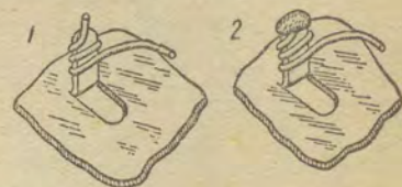
圖2 將導線和底板上或零件上鐸片鐸接的方法
