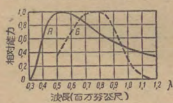
圖1 曲綫A——太陽光譜內能的分佈情況 曲綫B——矽光电管的色譜特性曲綫
