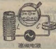
圖6 高频电源能够使L-C迴路裏的电子運動
