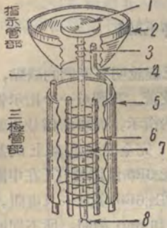
圖 1 1. 陰極遮光屏—其用途為遮去由陰極發出的紅光，和綠光相混淆。2. 螢光屏。3. 保護柵極—與陰極相連，其作用為節制大量電子飛向螢光屏，而把螢光屏損壞。4. 控制電極。5. 三極管屏極。6. 三極管柵極。7. 陰極。8. 燈絲。
