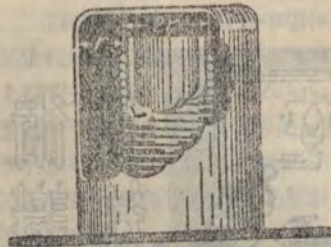
圖6 隔離罩離綫圈愈近，在綫圈中所引起的損失愈大。隔離罩離綫圈的最合適的距離如圖中所示。
