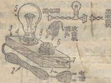
图1 测试灯 ①电源插头1只；②电源线1根；③双连木（普通木板亦可）1块；④矮脚灯头1只；⑤220或110伏25—40瓦电灯泡1只；⑥电源插座1只；⑦钩子螺丝钉1只；⑧12公厘长木螺丝4只。
