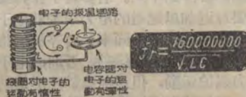
圖3 綫圈和電容器相互連接起來，使電子在這樣聯成的迴路裏可以振盪
