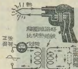
圖6 電源變压器綫圈短路
