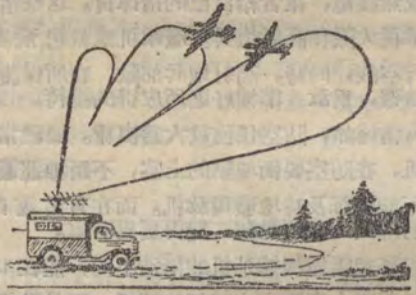
圖6 根據目標（在垂直面方向圖內）自一波飛到另一波瓣的過渡測定目標高度
