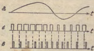
圖8 脈衝寬度及脈衝相位調制的原理： a—調制信號；b—當脈衝寬度調制時脈衝的寬度變化；c—當脈衝相位調制時脈衝的位置變化。
