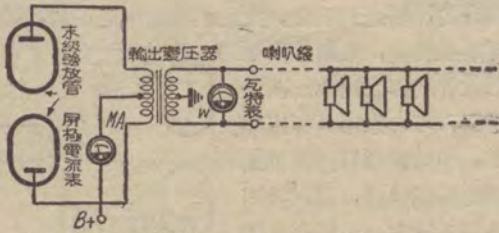
圖 1 有綫廣播機加裝「瓦特表」的接法
