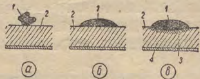
圖3 用鎔合法形成電子——空穴阻擋層的各個步驟：a—鎔合前；b—起初，錫鎔化成一滴液體附在鎘的表面上；c—溫度保持在500°—550°C若干時間以後。1—錫；2—電子導電性的鎘；3—空穴導電性薄層；4—另一電極。
