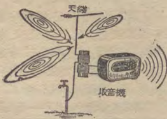
圖1 許多電台發送的電磁波會接觸到天線
