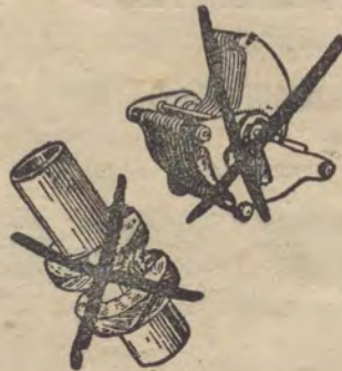
圖5 普通的綫圈和電容器在超短波裏是不合用的
