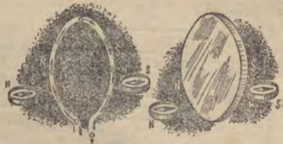
圖10 一個綫圈和一块磁鐵片一樣
