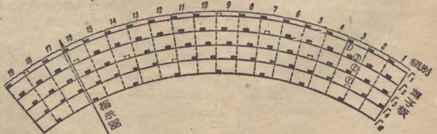
圖3 溫度發射器端子板上各牙齒的排列情形（已被替代的牙齒用虛線表示）
