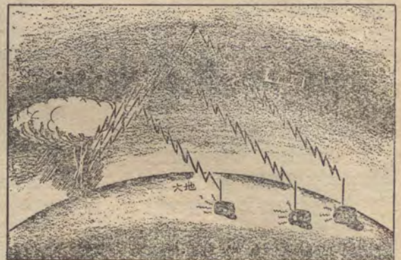
圖 2 遠處雷電經電離層反射，產生干擾
