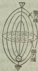
圖10 無線電台發出的電磁波
