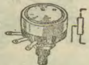
圖 18 電位器的外形和表示符號
