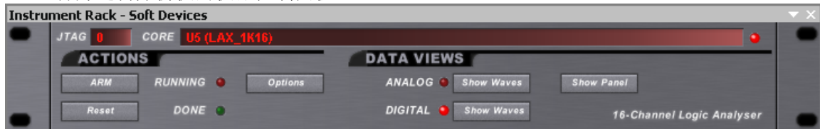
图 119 逻辑分析仪仪器控制面板
