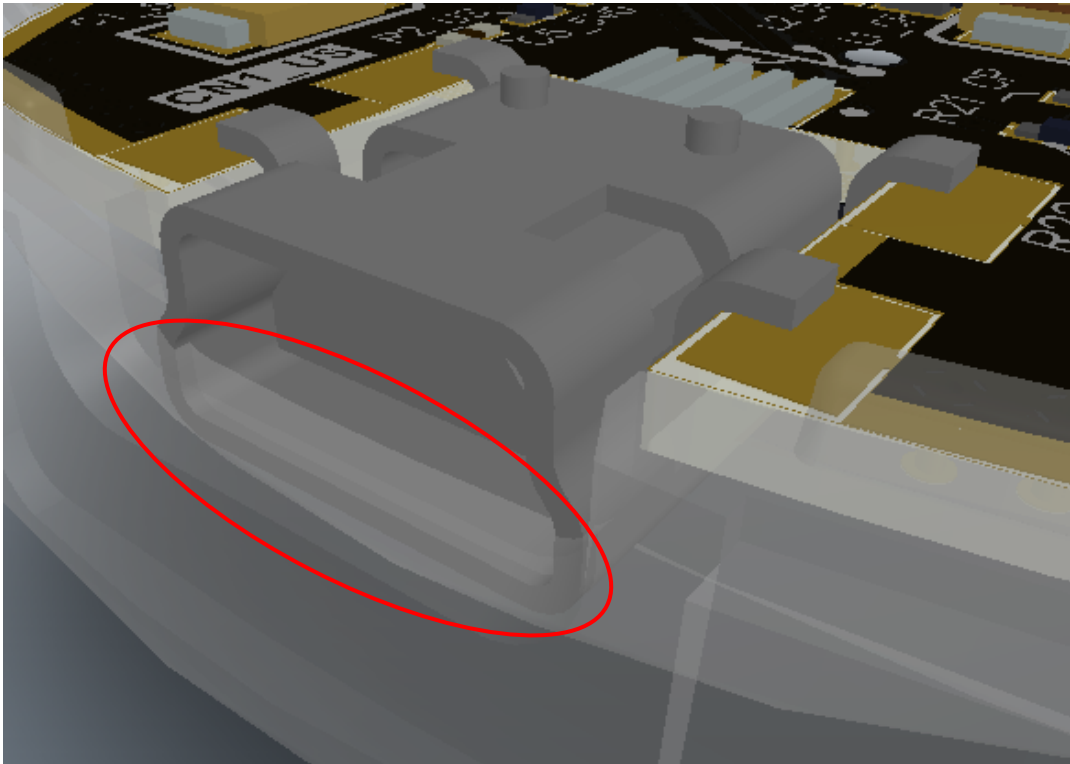
图 22.注意连接器件是如何装入的（在 DRC 检查禁止之后）
