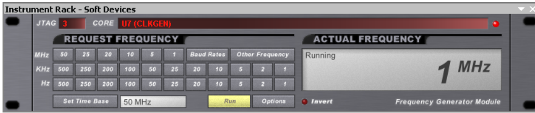
图 104. 频率发生器, 用来产生特定的频率
