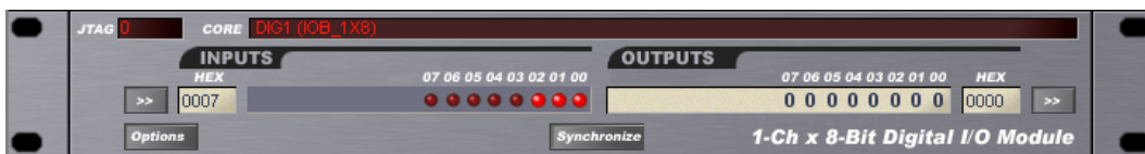
图 106. 数字 I/O 模块, 用来监测和控制设计中的节点电平
